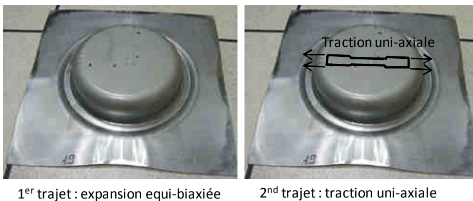
Figure 2.7 Essai d'expansion equi-biaxiée / traction uni-axiale.
