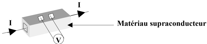
Figure 42 : Représentation schématique de la technique standard « mesure des 4 points » dans un matériau supraconducteur.
