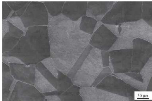
Figure 4.22 : Structure initiale de grain du matériau de Cu avant ECAE.
