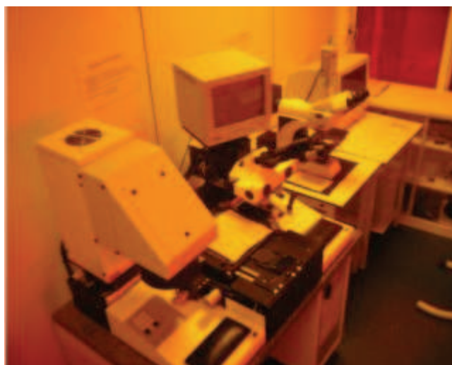
Fig. 47 Dispositif de lithographie optique au sein du Laboratoire de Physique des matériaux à Nancy.
