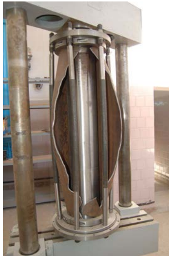
Figure 16 : Essai d'éclatement sur un tuyau X52 comportant un défaut de type d'entaille [30].
