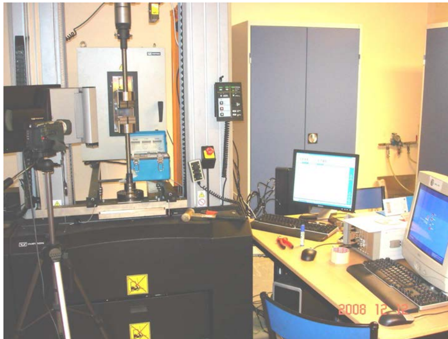
Figure 19 : Machine de traction/compression INSTRON 5585H équipée par émission acoustique.
