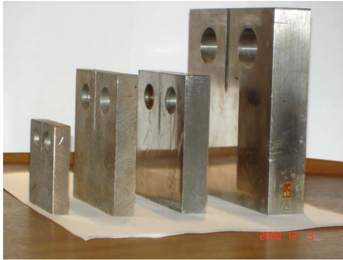
Figure 90 : Eprouvettes CT avec différentes épaisseurs.
