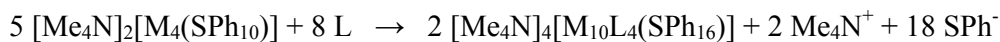
Fig. 2-6 : Synthèse du précurseur organométallique de taille \text{M}_{10}\text{L}_4 ( \text{M} = \text{Cd} ou \text{Zn} ) à partir du précurseur \text{M}_4 par ajout du chalcogène L.
