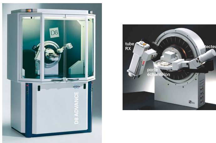
Fig. 4-27 : Diffractomètre X Bruker AXS D8 utilisé pour l'analyse cristallographique des NC de CdSe.
