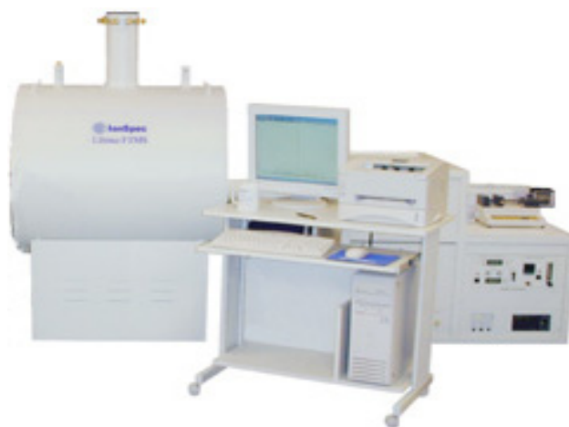
Fig. 3-9 : Dispositif HiRes 9,4Teslas Varian-Ionspec utilise pour la caractérisation des précurseurs de NC de SC par ESI-FTICRMS.
