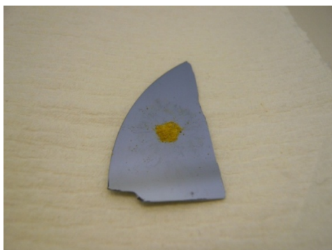
Fig. 6-9 : Dépôt de NC de CdS sur un substrat monocristallin de silicium (110) selon la procédure élaborée pour les NC de CdSe (§ 4.3.2).
