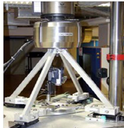
Figure 1.18. Dispositif de traction biaxiale, Institut Fraunhofer
