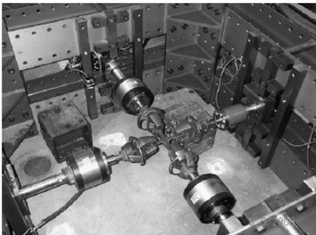
Figure 1.12. Dispositif d'essais biaxiaux
