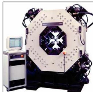
Figure 1.14. Système de traction biaxiale, Scholz et al., 2000
