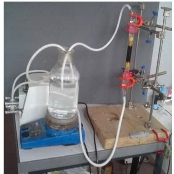
Figure III. 15: Dispositifs expérimentaux de la combinaison photocatalyse solaire et adsorption sur charbon actif
