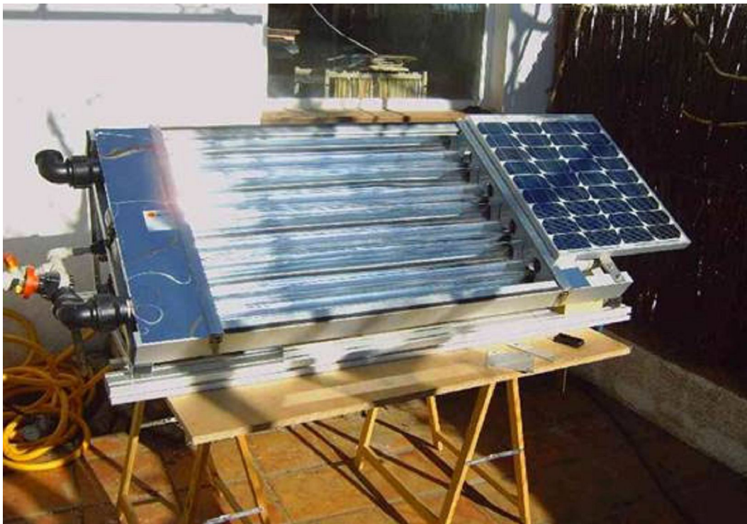
Figure I. 11 : Photocatalyseur pilote solaire totalement autonome permettant de fournir de l'eau potable à des communautés isolées sans eau ni électricité dans des régions semi-arides où l'éclairage solaire est considérable (Projets Solwater et Aquacat) 10 .
