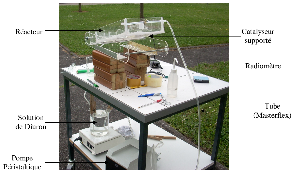
Figure I. 19 : Expériences de photocatalyse réalisée à Saint Avold le 12 mai 2008.
