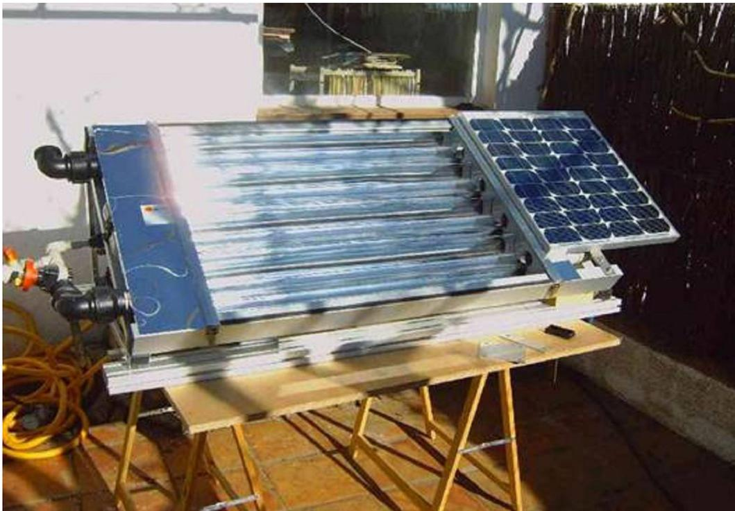
**Figure I. 11** : Photocatalyseur pilote solaire totalement autonome permettant de fournir de l'eau potable à des communautés isolées sans eau ni électricité dans des régions semi-arides où l'éclairage solaire est considérable (Projets Solwater et Aquacat)<sup>10</sup>.
