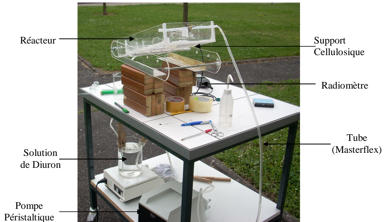
Figure III. 12 : Réacteur simple réalisé à partir de chutes de PMMA. Cette installation est utilisée à l'extérieur du laboratoire, pour les expériences au soleil (le 26 Août 2009 à 14h).
