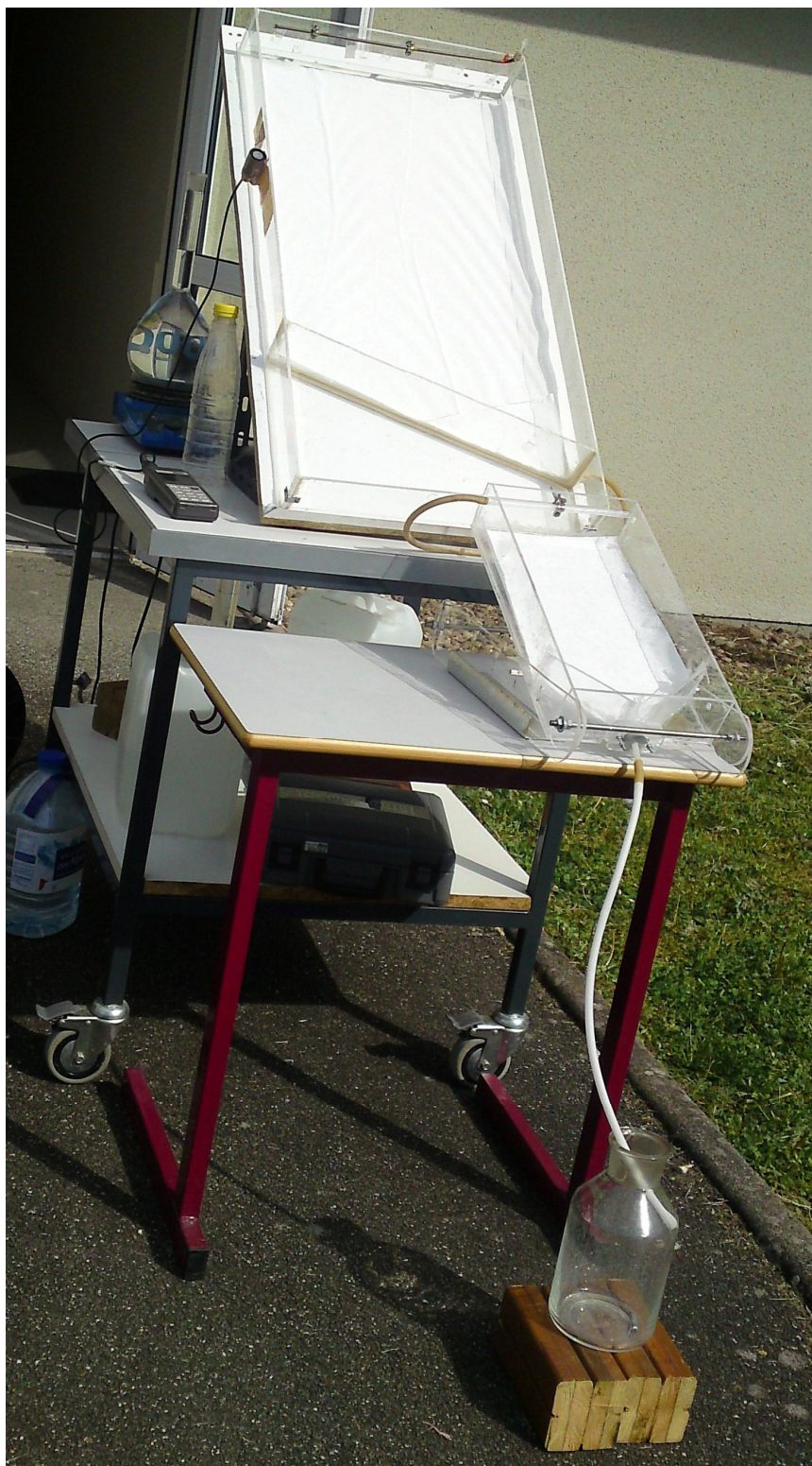
Figure III. 5 : Dispositif expérimental utilisé pour les tests photocatalytiques effectués sur la jonction des deux réacteurs simples (R+r).
