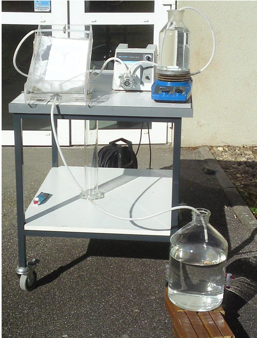
**Figure III. 3 :** Dispositif expérimental utilisé pour les tests photocatalytiques effectués sur le petit réacteur simple (r).
