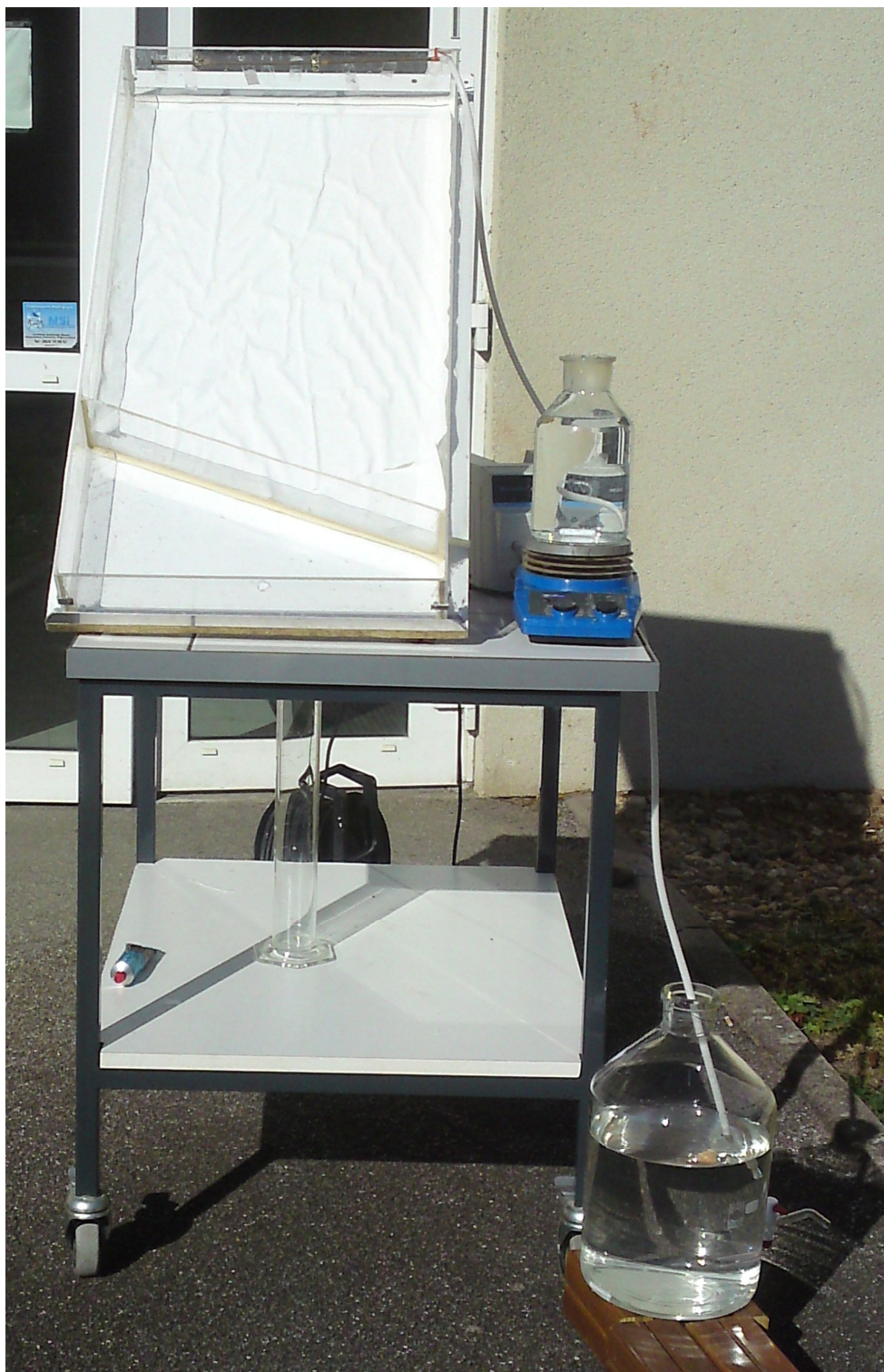
Figure III. 4 : Dispositif expérimental utilisé pour les tests photocatalytiques effectués sur le grand réacteur simple (R).
