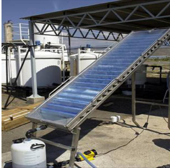
**Figure I. 8:** collecteur à non-concentration de type cascade utilisant le catalyseur supporté Ahlstrom (plate forme solaire d'Almeria, Espagne)<sup>44</sup>
