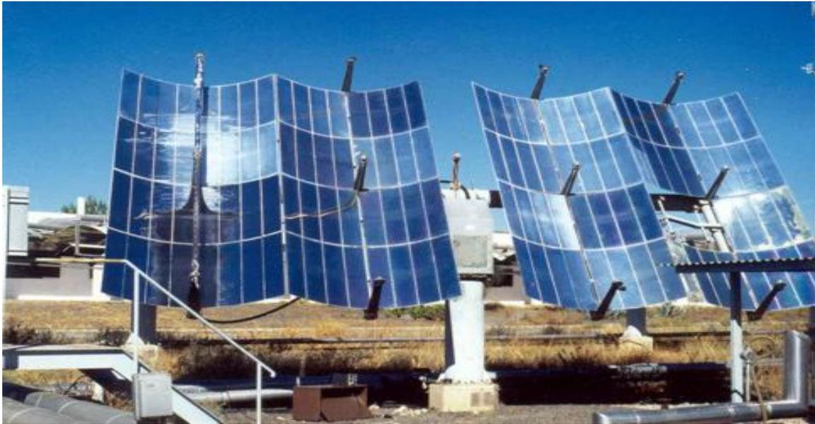
**Figure I. 9:** concentrateur en auge parabolique doté d'un système de suivie du soleil à deux axes, installé sur la plate forme solaire d'Almería en Espagne<sup>2</sup>.
