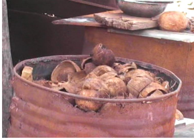
Photo II. 2: Barrique métallique servant de récipient pour la carbonisation des coques de noix de coco.
