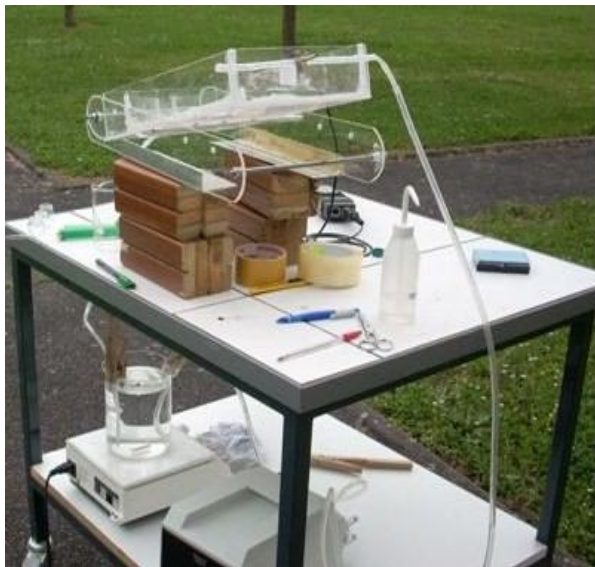
Figure III. 15: Dispositifs expérimentaux de la combinaison photocatalyse solaire et adsorption sur charbon actif
