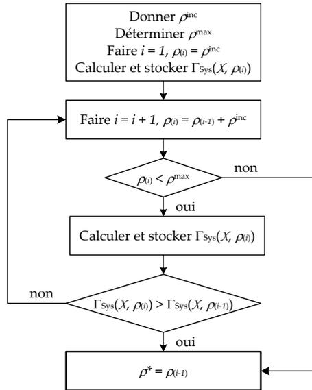
Figure 25 : Procédure numérique pour déterminer  $\rho^*$
