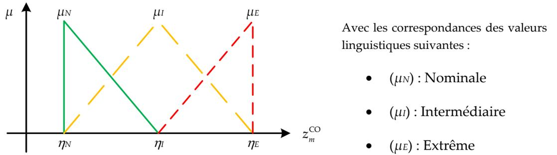
Figure 13 : Fonctions d'appartenance, avec trois ensembles, pour la variable linguistique « condition opérationnelle », associées à la mission  $m$
