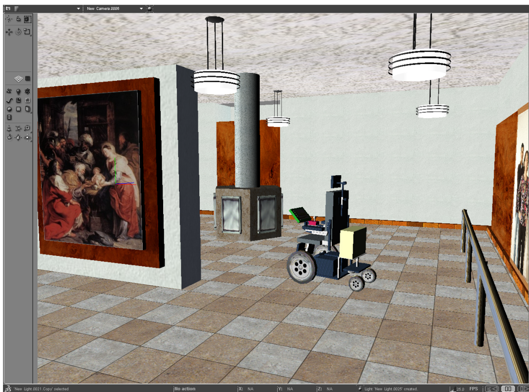
Figure 3.12 : Le simulateur conçu sous Virtools, l'utilisateur pilote directement le fauteuil virtuel à l'aide d'un joystick externe ou bien à l'aide d'une interface
