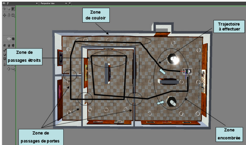
Figure 5.4 : Le parcours à réaliser dans un environnement contenant plusieurs types de configurations locales
