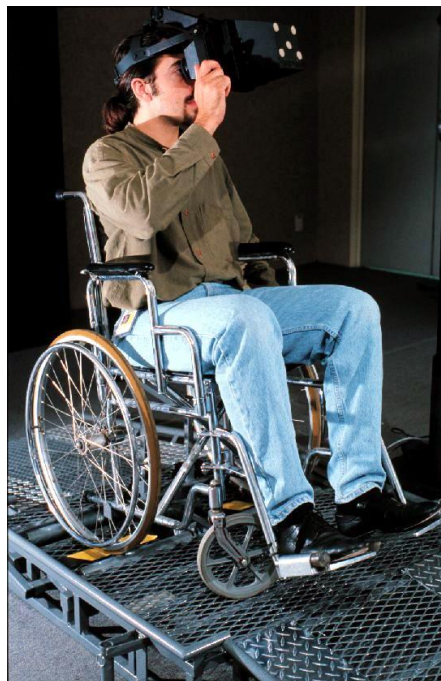
Figure 2.7 : Interface Ramp (Présentée à SIGGRAPH'95). Navigation dans une scène virtuelle en se servant d'un fauteuil comme d'une interface de commande.
