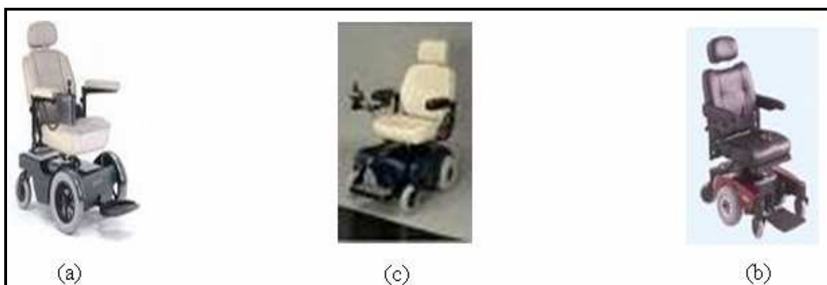
Figure II.2 : Fauteuil à traction avant (a), fauteuil à propulsion (c) et fauteuil mixte (b).
