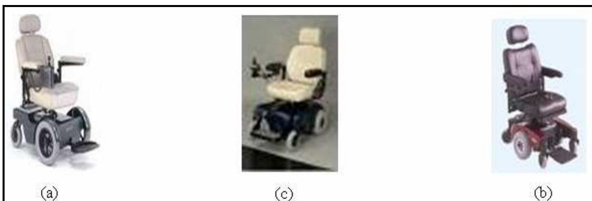
Figure II.2 : Fauteuil à traction avant (a), fauteuil à propulsion (c) et fauteuil mixte (b).
