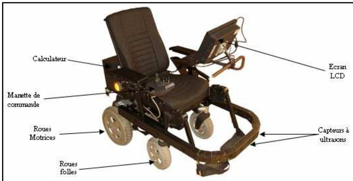
Figure II.3 : Fauteuil roulant électrique 'Storm' instrumenté.
