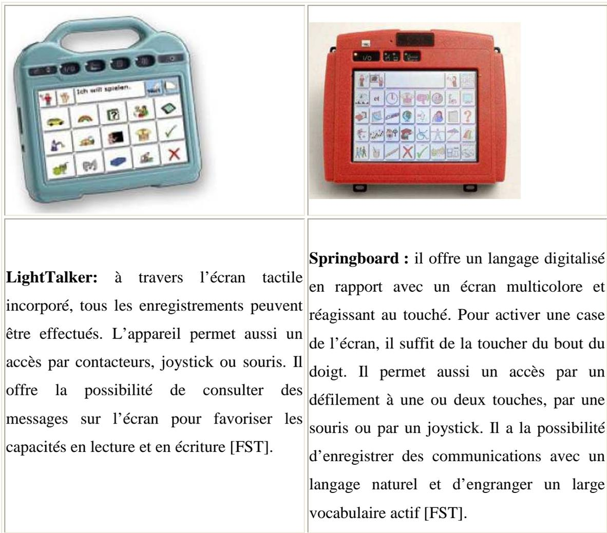
Figure I.9 : Appareils de communication à voix numérisée
