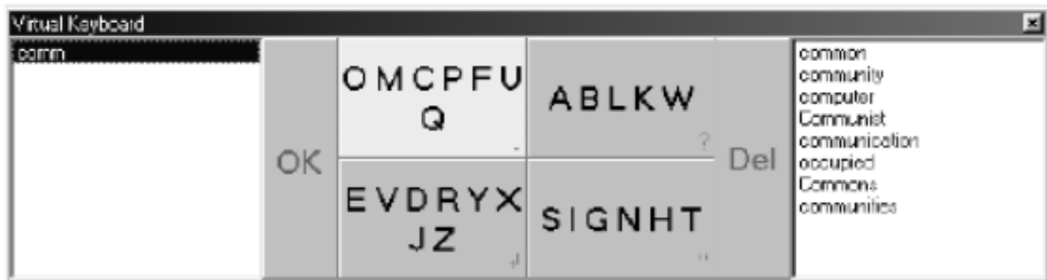
Figure I.14 : Le clavier ambigu UKO
