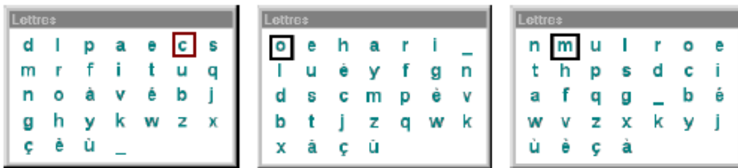
Figure I.12 : Modification de la disposition des touches après chaque saisie du mot « compter » [SCHA04]
