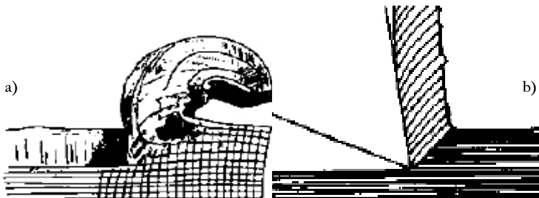
Figura 1.8: Ilustraciones sobre la formación de la viruta según Tresca (a) y Mallock (b).
