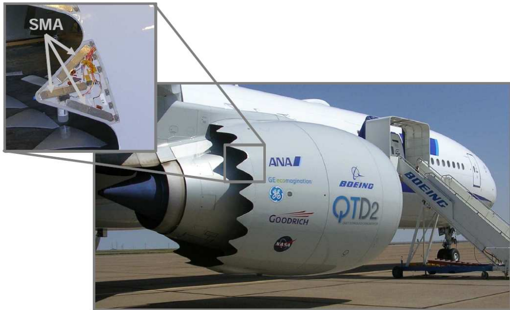
FIG. 1.12: Chevrons sur un réacteur Boeing utilisant des actionneurs en AMF, d'après [Hartl et Lagoudas, 2007]
