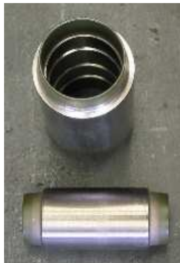
FIG. 1.9: Manchon de serrage en NiTi (Intrinsicdevices)
