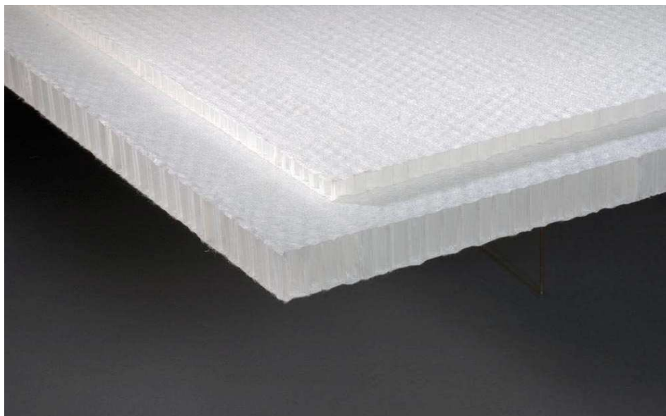
Figure 2.2 Structure en nid d'abeille polypropylène
