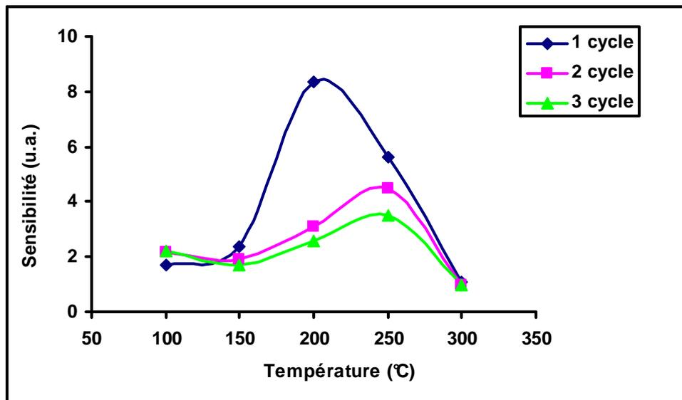
*Figure VI-7: Sensibilité de In<sub>2</sub>O<sub>3</sub> dopé Sn à 10ppm de H<sub>2</sub>S en fonction de la température de fonctionnement.*
