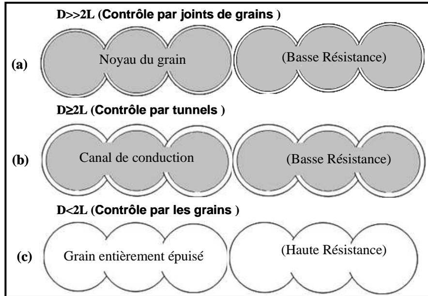
**Figure II-7: Représentation schématique de l'effet de la taille des cristallites sur la sensibilité d'un capteur à base d'oxyde métallique: (a)  $D \gg 2L$  (contrôle par joints de grains); (b)  $D \geq 2L$  (contrôle par tunnels); (c)  $D < 2L$  (contrôle par les grains) [29].**
