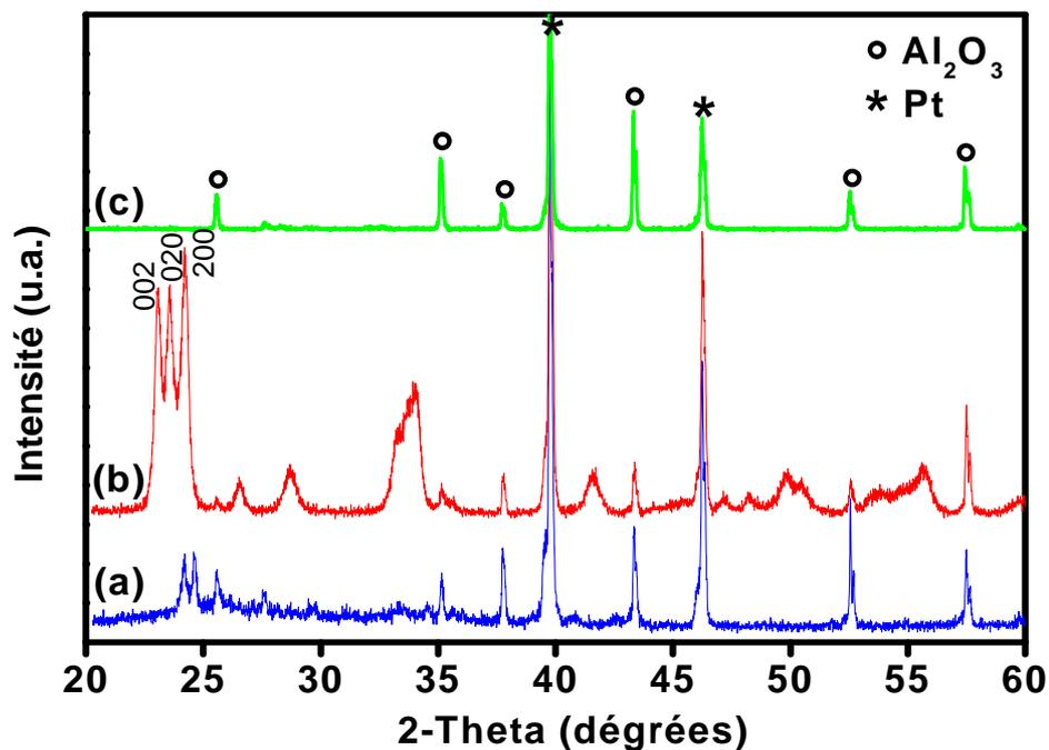
*Figure VII-6: Spectres de DRX des couches minces de (a)  $WO_3$  déposées à  $350^\circ\text{C}$  ( $1\text{ml/h}$  pendant  $1\text{h}$ ) et (b) recuites dans l'air à  $500^\circ\text{C}$  pendant  $2\text{h}$ , (c) substrat.*
