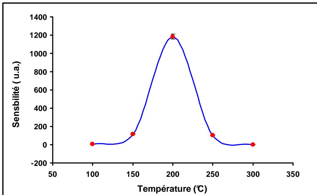
Figure VII-9: La sensibilité de WO<sub>3</sub> à 10ppm de H<sub>2</sub>S en fonction de la température de fonctionnement.
