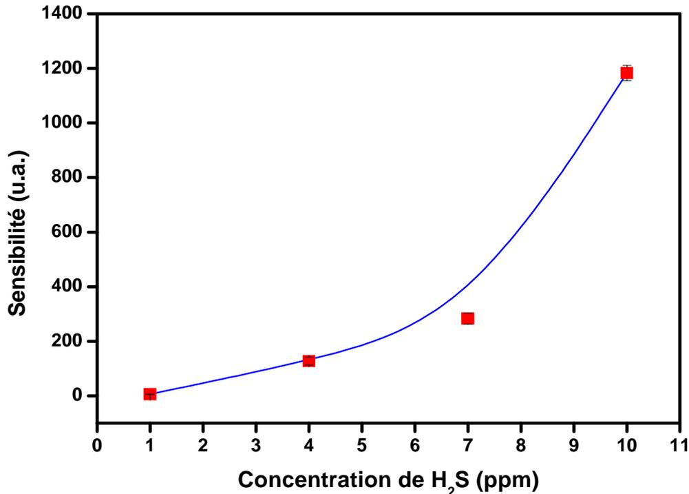
Figure VII-10: La sensibilité de WO<sub>3</sub> en fonction de la concentration de H<sub>2</sub>S pour une température de fonctionnement de 200°C.
