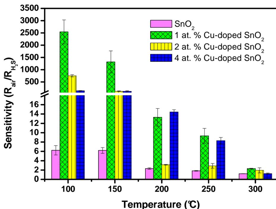
Figure IV-10: La sensibilité de SnO<sub>2</sub> et SnO<sub>2</sub> dopé Cu à 10ppm H<sub>2</sub>S en fonction de la température des couches minces.
