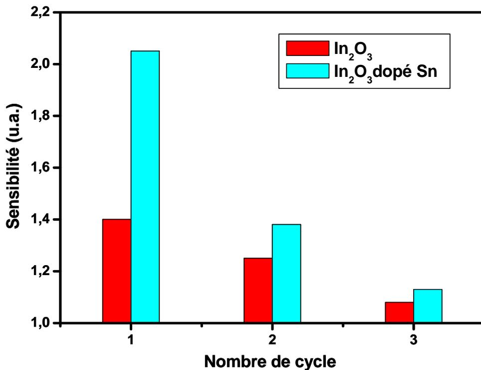
Figure VI-11: Sensibilité de In<sub>2</sub>O<sub>3</sub> et In<sub>2</sub>O<sub>3</sub> dopé Sn à 1ppm NO<sub>2</sub> pour une température de fonctionnement de 200°C.
