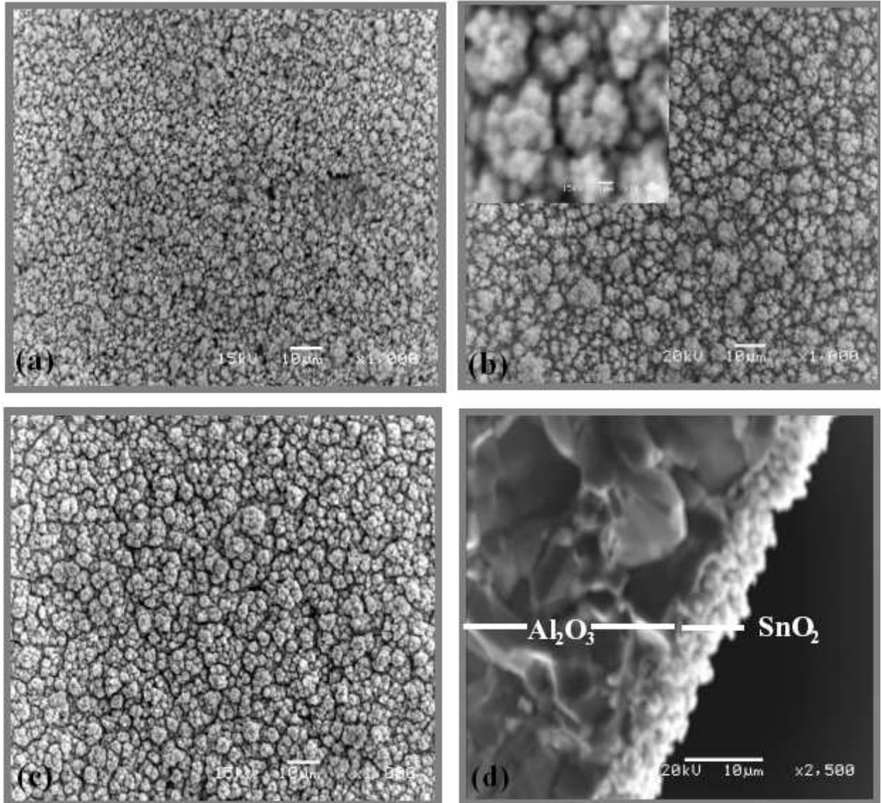
*Figure IV-3: Images par MEB des couches minces de SnO<sub>2</sub> déposées à 400 °C pendant 1h en utilisant les différents débits de précurseurs: (a) 1ml/h-vue supérieure, (b) 2ml/h-vue supérieure, (c) 4ml/h-vue supérieure, (d) 2ml/h-vue en section.*
