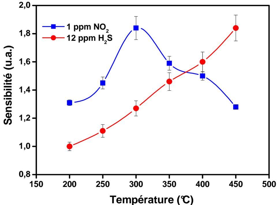
Figure V-5: Sensibilité du capteur de ZnO à 1ppm de NO<sub>2</sub> et 12ppm de H<sub>2</sub>S pour différentes températures de fonctionnement.
