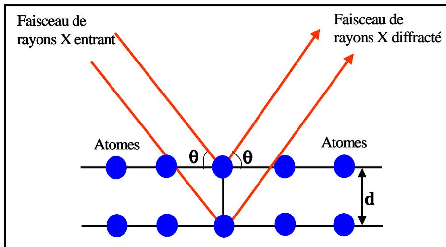
Figure III-8: Schéma de la loi de Bragg.
