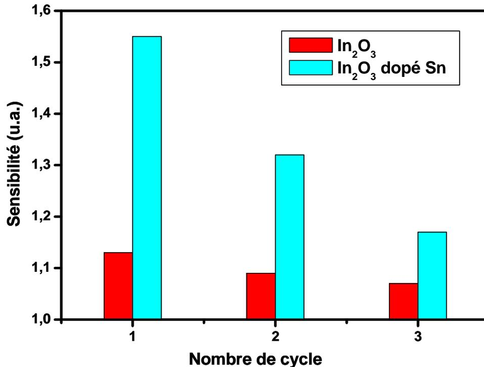
Figure VI-10: Sensibilité de  $In_2O_3$  et  $In_2O_3$  dopé Sn à 20ppm  $SO_2$  pour une température de fonctionnement de 200°C.
