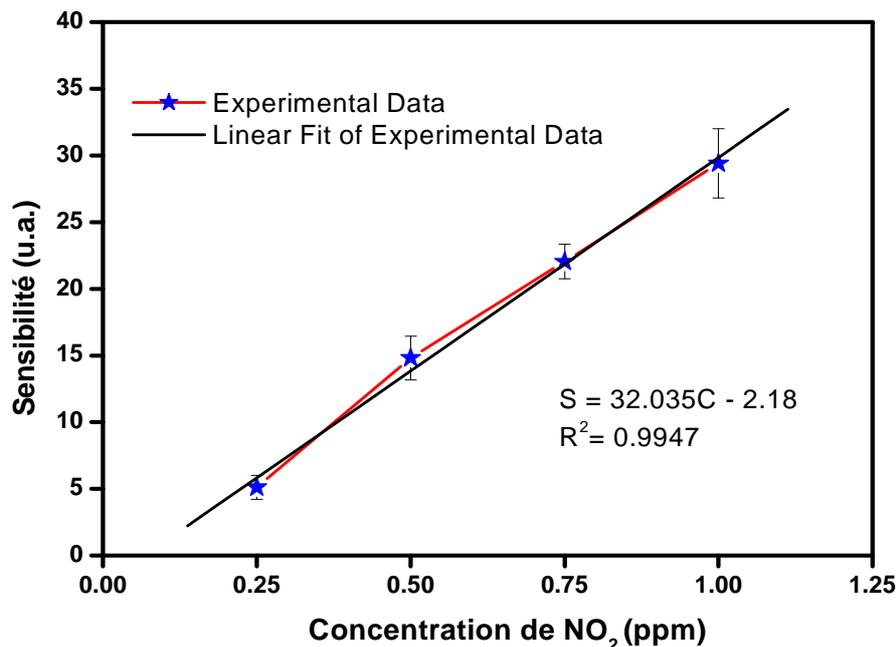
*Figure VII-12: La sensibilité de  $\text{WO}_3$  en fonction de la concentration de  $\text{NO}_2$  pour une température de fonctionnement de  $150^\circ\text{C}$ .*
