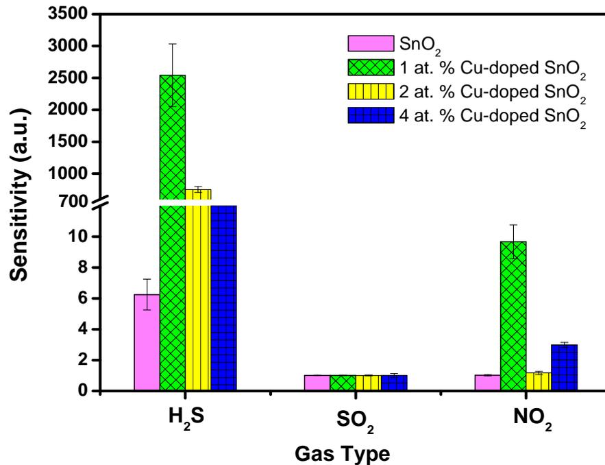
*Figure IV-13: Les sensibilités des couches minces de SnO<sub>2</sub> et SnO<sub>2</sub> dopé Cu à 10ppm H<sub>2</sub>S, 20ppm SO<sub>2</sub> et 1ppm NO<sub>2</sub> pour une température de 100 °C.*
