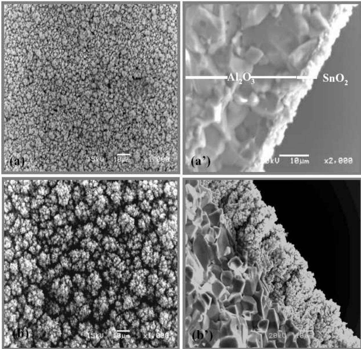
*Figure IV-2: Images par MEB des couches minces de SnO<sub>2</sub> déposées avec 1ml/h à 400 °C en utilisant les différents temps de dépôt: (a) 1h-vue supérieure (a') 1h-vue en section, (b) 3h-vue supérieure, (b') 3h-vue en section.*
