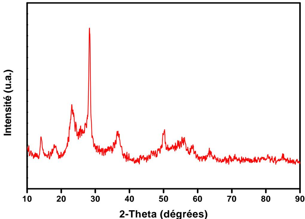
*Figure VII-3: Spectres par DRX de poudre de  $\text{WO}_3 \cdot 1/3\text{H}_2\text{O}$  obtenue en séchant la solution de PTA à  $60^{\circ}\text{C}$ .*
