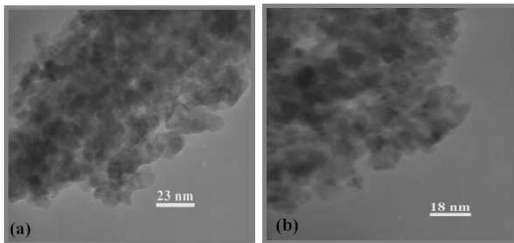
*Figure IV-6: Images par MET des couches de: (a) SnO<sub>2</sub> et (b) SnO<sub>2</sub> dopé 4 at.% Cu déposées à 400 °C (2ml/h pendant 1h) et recuit dans l'air à 550 °C pour 2h.*
