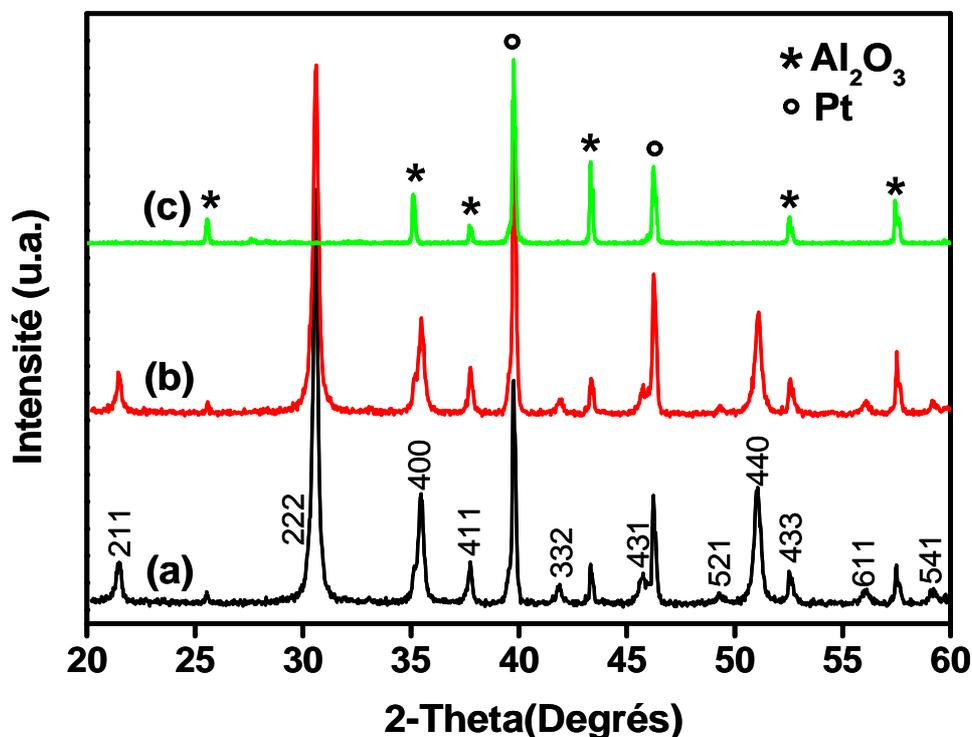
Figure VI-2: Spectres par DRX de (a)  $\text{In}_2\text{O}_3$  (b)  $\text{In}_2\text{O}_3$  dopé Sn et (c) Substrat ( $\text{Pt-Al}_2\text{O}_3$ ).
