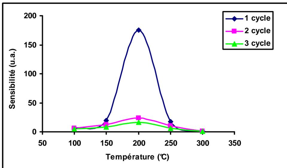
Figure VI-6: Sensibilité de In<sub>2</sub>O<sub>3</sub> à 10ppm de H<sub>2</sub>S en fonction de la température de fonctionnement.
