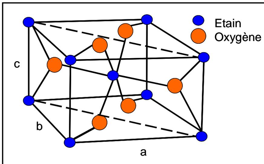
Figure II-8: Cellule unitaire tétragonale de  $\text{SnO}_2$ .
