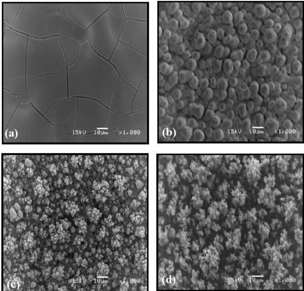
*Figure VII-4: Images par MEB des couches minces de WO<sub>3</sub> déposées à 1ml/h pour 1h en utilisant différentes températures de dépôt: (a) 200 °C, (b) 300 °C, (c) 350 °C, (d) 400 °C.*
