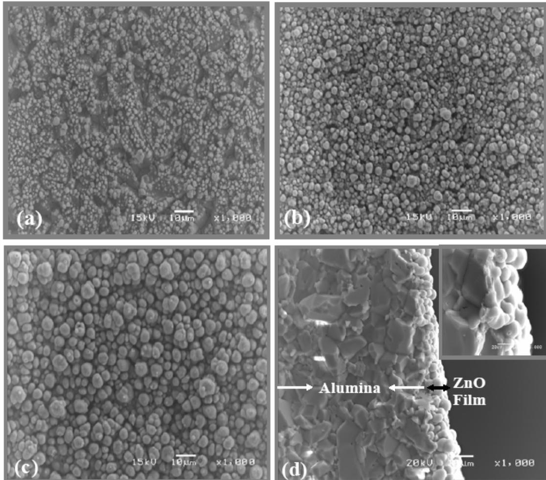
**Figure V-1: Image par MEB d'une couche mince de ZnO déposée sur de l'alumine recouverte de Pt à  $350^{\circ}\text{C}$  avec un débit de (a) 1ml/h pendant 1h; (b) 2ml/h pendant 1h; (c) 2ml/h pendant 2h vue de dessus et (d) 2ml/h durant 2h vue d'une coupe transversale.**
