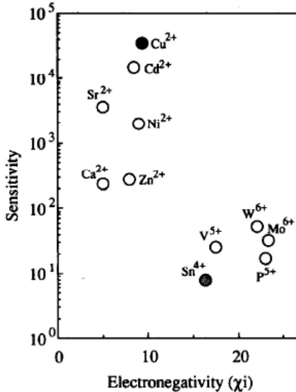
Figure IV-9: La sensibilité de capteur de SnO<sub>2</sub> en fonction des électronégativités des cations ajoutés [107].
