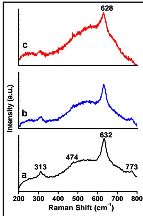
*Figure IV-8: Spectres Raman des couches minces de (a) SnO<sub>2</sub> et SnO<sub>2</sub> dopé (b) 1 at.% Cu et (c) 4 at.% Cu déposées à 400 °C (2ml/h pendant 1h) et recuit dans l'air à 550 °C pour 2h.*
