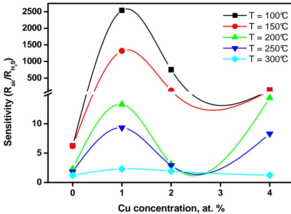
Figure IV-11: La sensibilité de SnO<sub>2</sub> à 10ppm de H<sub>2</sub>S en fonction de la concentration en cuivre pour différentes températures étudiées.
