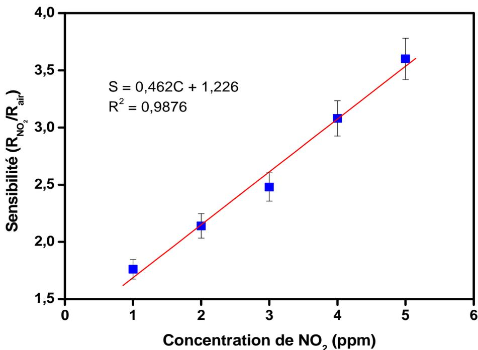
Figure V-6: Sensibilité de ZnO à 300°C pour différentes concentrations de NO<sub>2</sub>.
