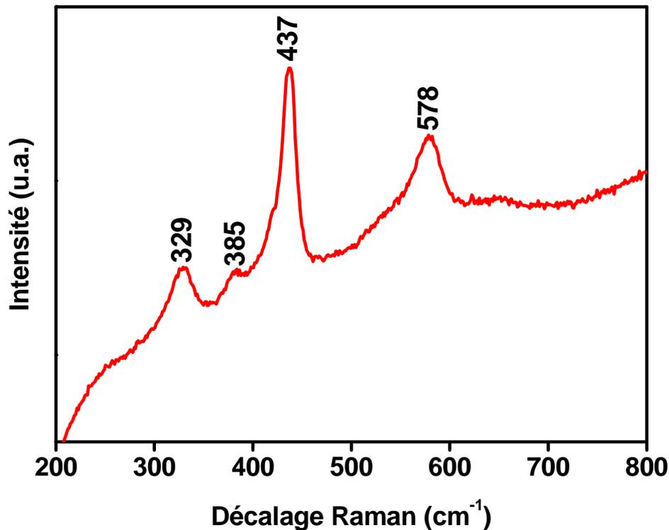
*Figure V-4: Spectres Raman à température ambiante d'une couche mince de ZnO déposée sur de l'alumine recouverte de Pt à  $350^{\circ}\text{C}$  (2 ml/h pour 2h) et recuite à  $600^{\circ}\text{C}$  à l'air pendant 2h.*
