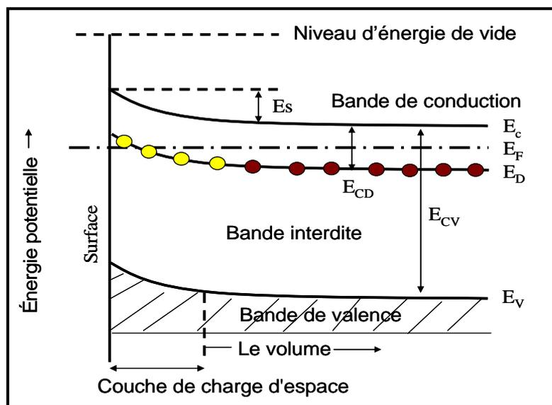
**Figure II-5: Diagramme d'énergie pour  $\text{SnO}_{2-x}$  avec l'oxygène adsorbé chargé négativement, où:  $E_s$ : barrière de potentiel;  $E_F$ : Niveau de Fermi ;  $E_D$ : niveau donneur;  $E_C$ : le plus bas niveau de la Bande de Conduction;  $E_V$ : le plus haut niveau de la Bande de Valence ;  $E_{CD}$ : profondeur du niveau donneur;  $E_{CV}$ : bande d'énergie entre  $E_C$  et  $E_V$  [28].**
