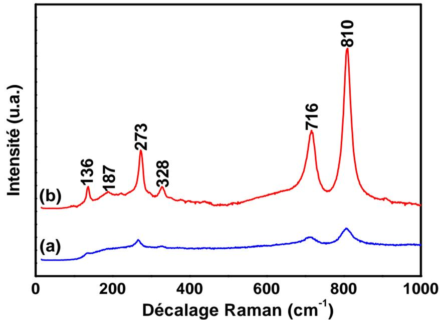
*Figure VII-8: Spectres de Raman d'une couche mince de (a)  $\text{WO}_3$  déposée à  $350\text{ °C}$  ( $1\text{ml/h}$  pendant  $1\text{h}$ ) et (b) la même couche mais recuite dans l'air à  $500\text{ °C}$  pendant  $2\text{h}$ .*
