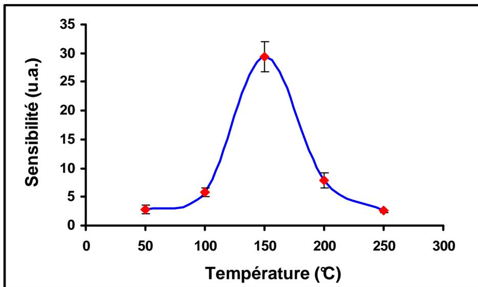
*Figure VII-11: La sensibilité de  $\text{WO}_3$  à 1ppm de  $\text{NO}_2$  en fonction de la température de fonctionnement.*
