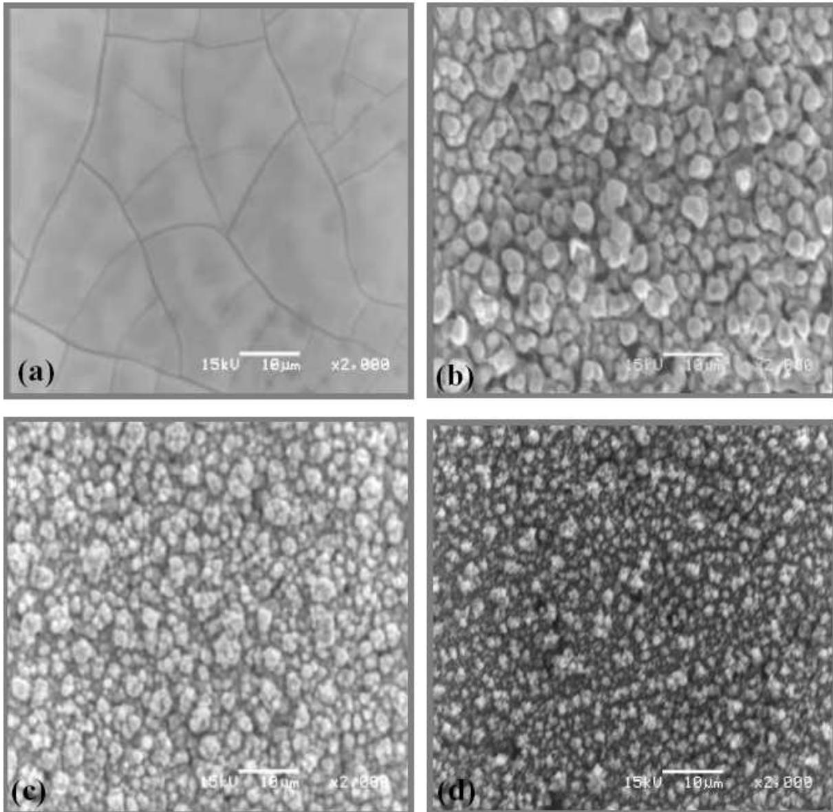
*Figure IV-1: Images par MEB des couches minces de SnO<sub>2</sub> déposées avec 1ml/h pour 1 h en utilisant les différentes températures de dépôt: (a) 150 °C, (b) 250 °C, (c) 350 °C, (d) 400 °C.*
