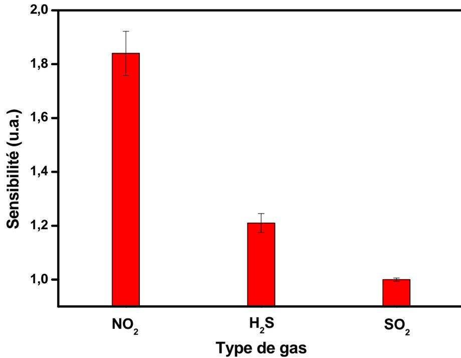
*Figure V-8: Sensibilité de ZnO à 1ppm de NO<sub>2</sub>, 10ppm de H<sub>2</sub>S et 20ppm de SO<sub>2</sub> à une température de fonctionnement de 300°C.*
