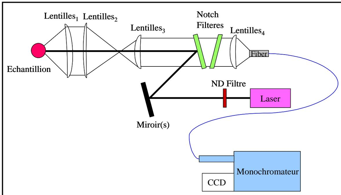
Figure III-10: Représentation schématique du dispositif de Raman.
