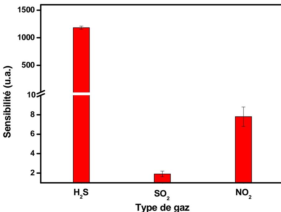
*Figure VII-13: La sensibilité de WO<sub>3</sub> à 10ppm de H<sub>2</sub>S, 20ppm de SO<sub>2</sub> et 1ppm de NO<sub>2</sub> pour une température de fonctionnement de 200°C.*
