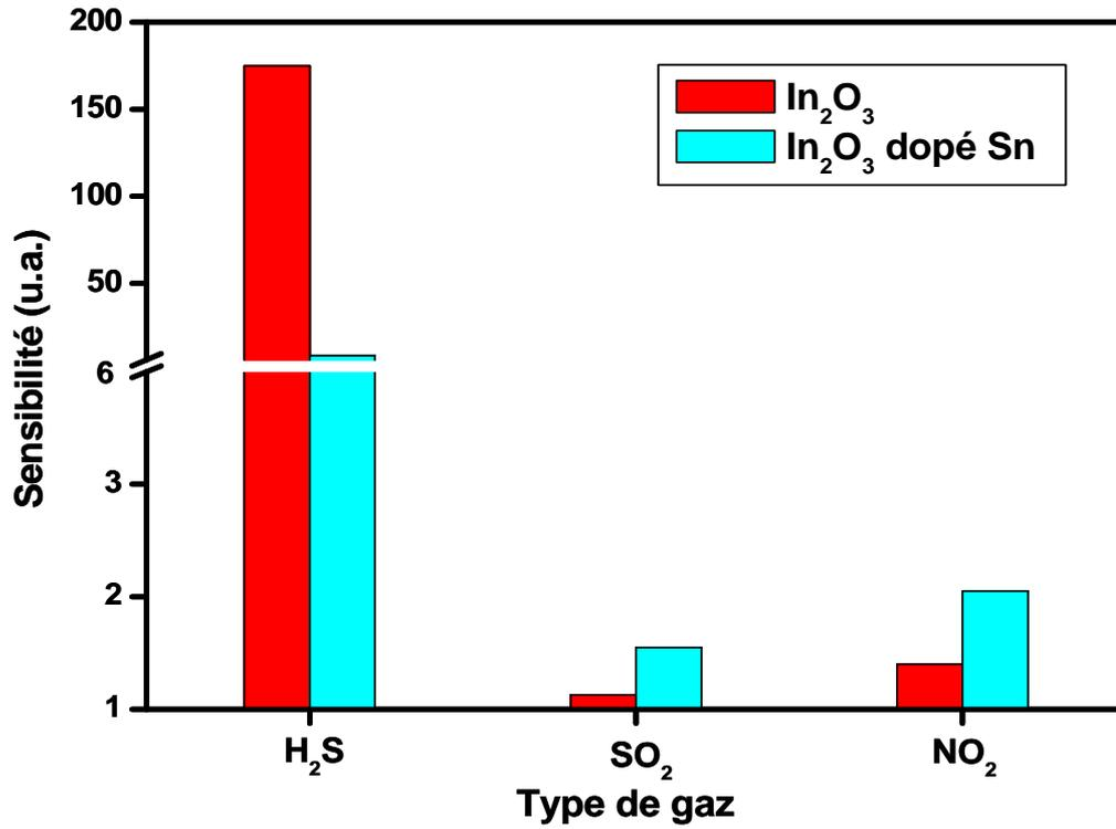
Figure VI-12: Sensibilité de  $\text{In}_2\text{O}_3$  et  $\text{In}_2\text{O}_3$  dopé Sn à 10ppm de  $\text{H}_2\text{S}$ , 20ppm de  $\text{SO}_2$  et 1ppm de  $\text{NO}_2$  à la température de fonctionnement de 200 °C.
