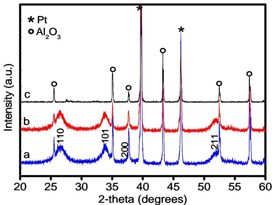
*Figure IV-5: Spectres par DRX de couches minces de (a)  $\text{SnO}_2$ , (b)  $\text{SnO}_2$  dopé 4 at.% Cu et (c) Substrat ( $\text{Pt-Al}_2\text{O}_3$ ).*
