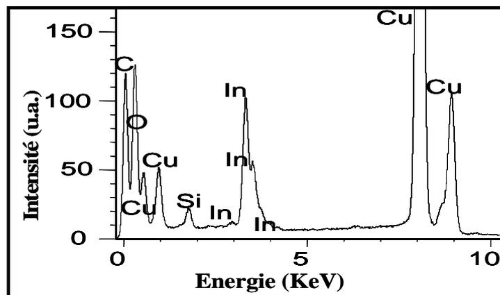
*Figure VI-4: Spectres d'EDX des couches de  $\text{In}_2\text{O}_3$  déposées à 400°C (1.5 ml/h pour 1h) et recuites dans l'air à 500°C pendant 2h.*
