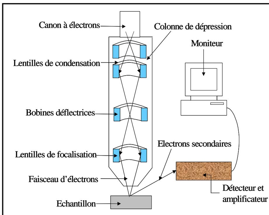
Figure III-7: Vue schématique du Microscope Electronique à Balayage.
