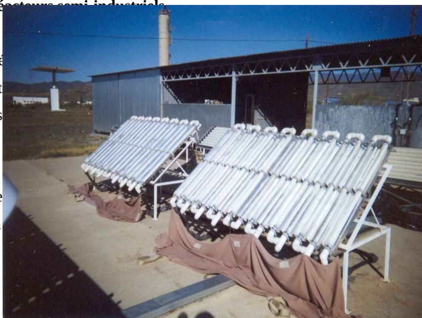
Figure I.17 : Installation pilote de la plateforme solaire d'Almería en Espagne permettant de dépolluer 300 litres d'eau par jour [60]
