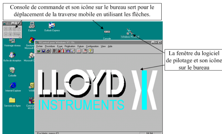
FIGURE A.1 – Fenêtre du logiciel lié au pilotage de la machine.
