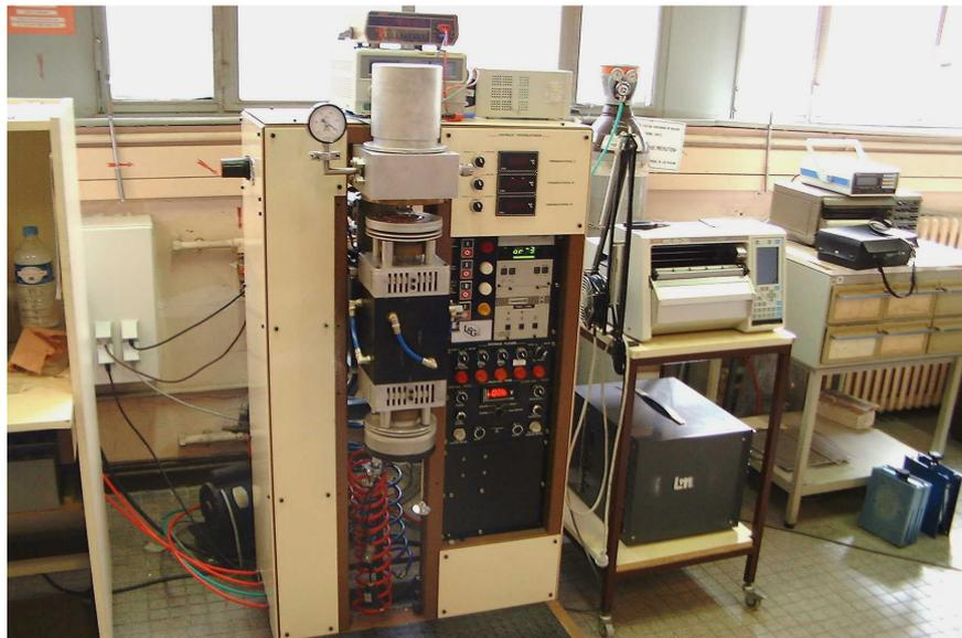
**Figure 2.2 Dilatomètre à Cycle Rapide (DCR) du LSG2M**
