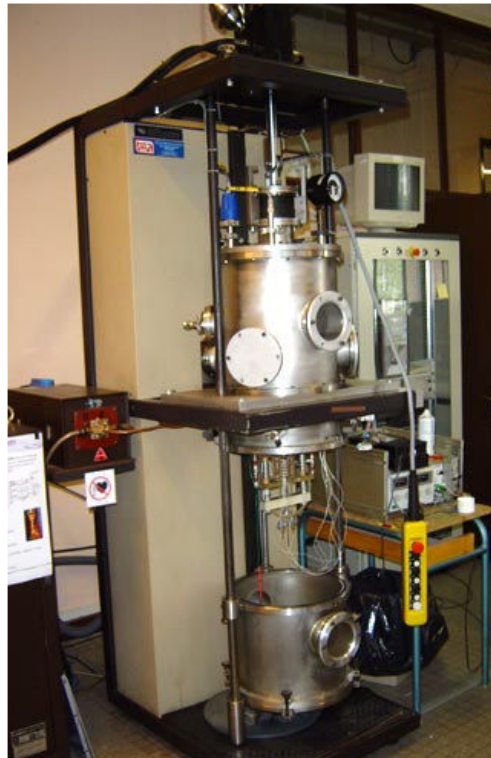
Figure 2.6 Simulateur thermomécanique DITHEM du LSG2M
