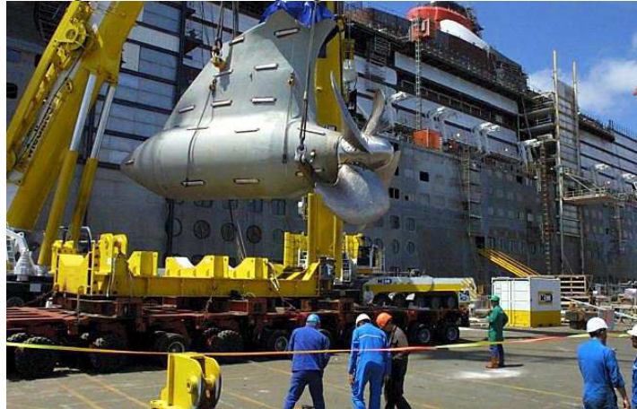
Figure 1.2 : Installation d'un POD (Queen Mary II- http://www.worldshipny.com )
