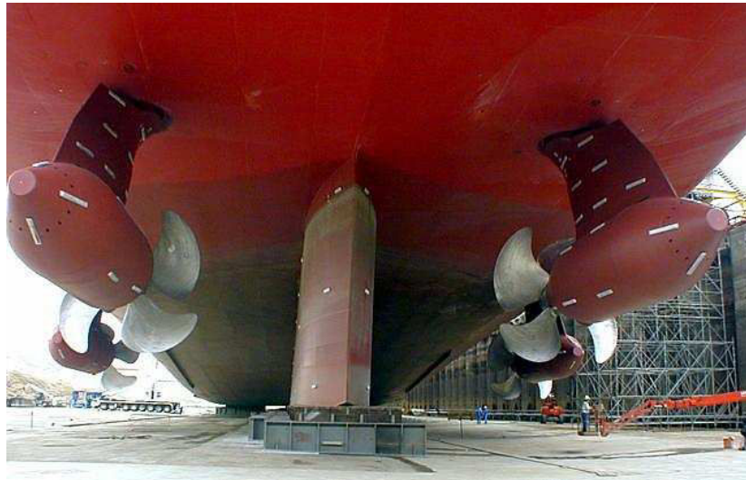
Figure 1.4 : Vue des quatre POD de type Mermaid™ sur le Queen Mary II ( http://www.worldshipny.com )
