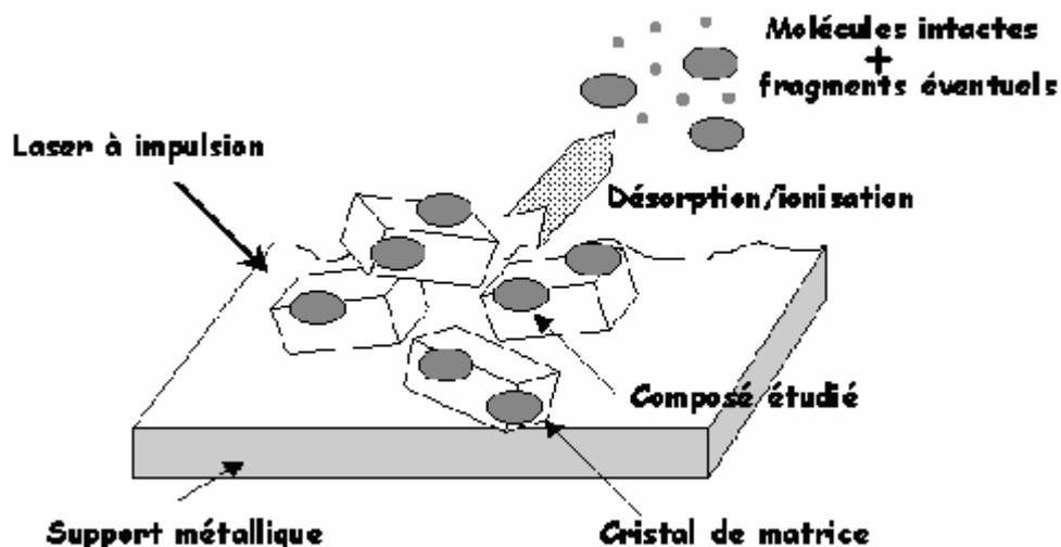
Figure 17 : Principe de la technique MALDI
