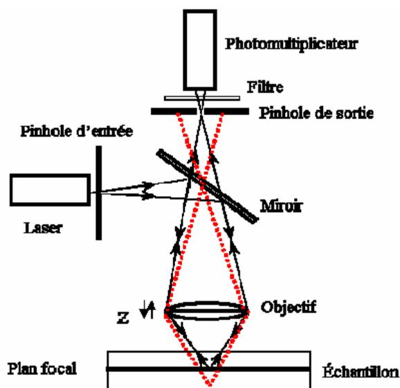
Figure 16 : Principe de la microscopie confocale
