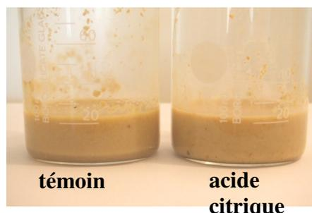
Figure D-23 : Photographie de l'émulsion obtenue après traitement à l'Alcalase® (pH 8, 60°C, 2h, E/S : 3%) et cellulase (pH4,5, 55°C, 2h, E/S 1%) après addition d'acide citrique.
