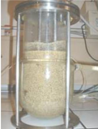
**Figure C-7 : Photographie du réacteur permettant l'hydrolyse du milieu.**
