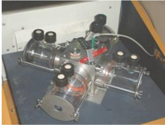
**Figure C-11 : Photographie du module de filtration à quatre compartiments permettant la filtration de l'émulsion.**
