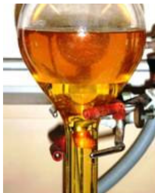
Figure D-1 : Photographie représentant la phase de décantation lors de la méthode de Bligh & Dyer. La phase supérieure colorée correspond à la phase aqueuse méthanolique, alors que la phase inférieure correspond à la phase chloroformique contenant les lipides.
