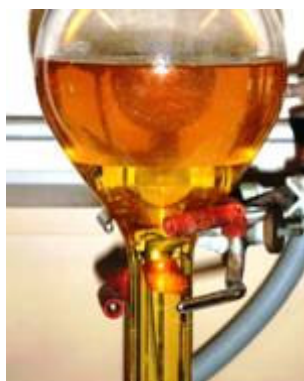
Figure D-1 : Photographie représentant la phase de décantation lors de la méthode de Bligh & Dyer. La phase supérieure colorée correspond à la phase aqueuse méthanolique, alors que la phase inférieure correspond à la phase chloroformique contenant les lipides.
