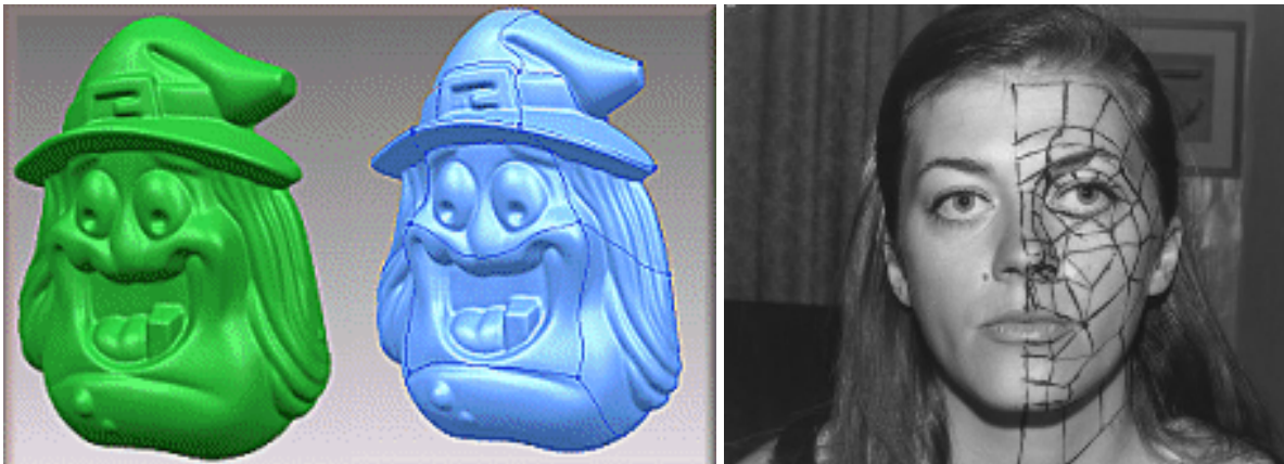
FIG. 1.2: Gauche : construction manuelle d'un maillage de contrôle CAGD/CAM [Rap] à partir d'un maillage triangulaire ; Droite : numérisation d'un objet réel par acquisition manuelle (l'image est tiré de la thèse de Henri Gouraud [Gou71b]).
