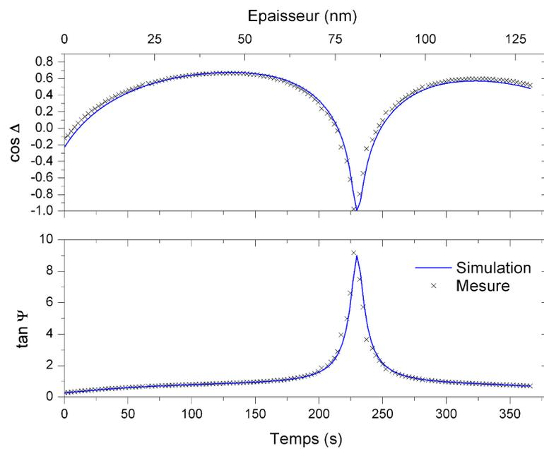
**FIGURE 3.14** – Représentation des paramètres ellipsométriques  $\Psi$  et  $\Delta$  à  $\lambda = 350$  nm en fonction du temps pendant la croissance du dépôt en conditions oxydantes. Paramètres de dépôt au **tableau 3.3**.
