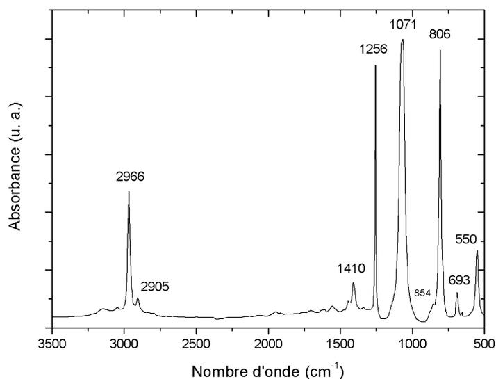
FIGURE 4.10 – Spectre infrarouge de l'octaméthylcyclotétrasiloxane liquide [14].
