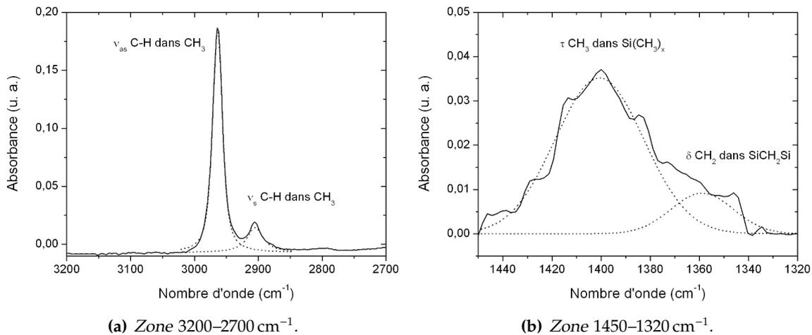
**FIGURE 4.22** – Indexation et déconvolution des zones d'absorption infrarouge entre 3200 et 2700 cm<sup>-1</sup> et entre 1450 et 1320 cm<sup>-1</sup> pour un film mince réalisé à partir d'une décharge de précurseur pur. Conditions de dépôt au tableau 4.8.
