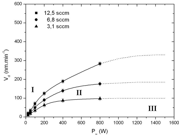
**FIGURE 3.2** – Évolution de la vitesse de dépôt dans le cas d'un gaz de dilution réducteur (hydrogène) en fonction de la puissance délivrée par le générateur pour différents débits de gaz de précurseur.
