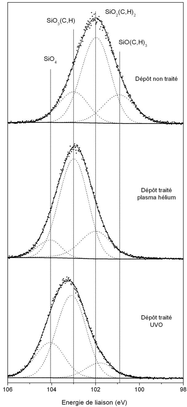
**FIGURE 5.16** – Déconvolution des raies Si<sub>2p</sub> pour le dépôt de référence, le dépôt traité par plasma hélium pendant 10 min et le dépôt traité par UVO pendant 10 min.
