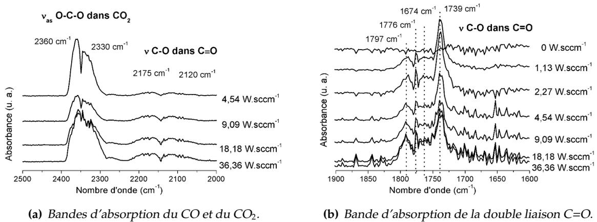
**FIGURE 4.14** – Absorption infrarouge de la phase gazeuse pour le cas du mélange OMCTSO/oxygène dans la région 2500–1500 cm<sup>-1</sup>.
