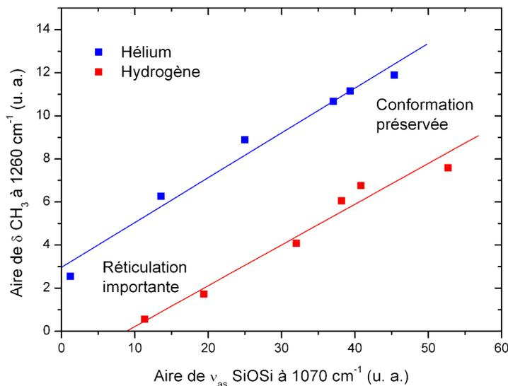
**FIGURE 4.32** – Évolution de l'aire de la bande d'absorption de  $\delta$  CH<sub>3</sub> en fonction de celle de  $\nu_{as}$  SiOSi cyclique.
