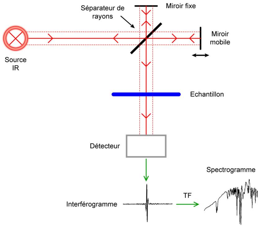
**FIGURE 2.1** – Schéma de principe de l'analyse par spectroscopie d'absorption infrarouge.
