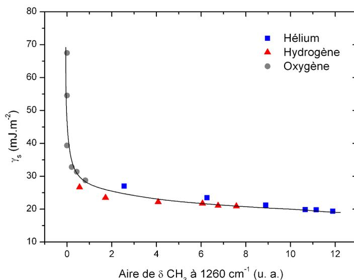
**FIGURE 5.3** – Énergie de surface des matériaux obtenus par les trois cas étudiés pour différentes valeurs de  $\mathcal{P}_{cp}$  en fonction de l'aire de la bande d'absorption de  $\delta \text{CH}_3$ .
