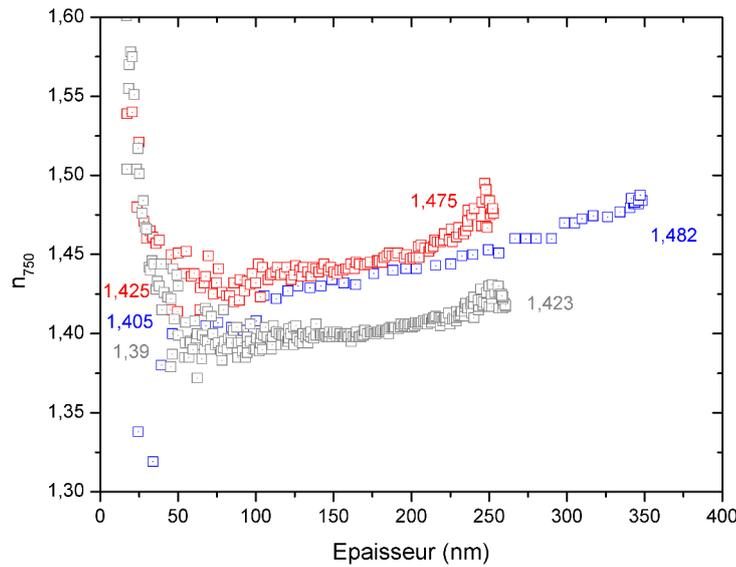
**FIGURE 3.17** – Évolution au cours de la croissance de l'indice optique à  $\lambda = 750$  nm des couches minces pour les trois procédés étudiés en fonction de l'épaisseur du dépôt. Conditions de dépôt au **tableau 3.3**.
