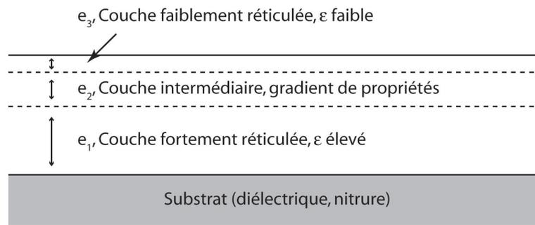
**FIGURE 7.5** – Structure retenue pour l'intégration du polydiméthylcyclosiloxane à faible hystérésis de mouillage dans un dispositif d'électro-mouillage sur diélectrique. La synthèse est effectuée de manière continue afin de ne pas présenter d'interfaces franches.
