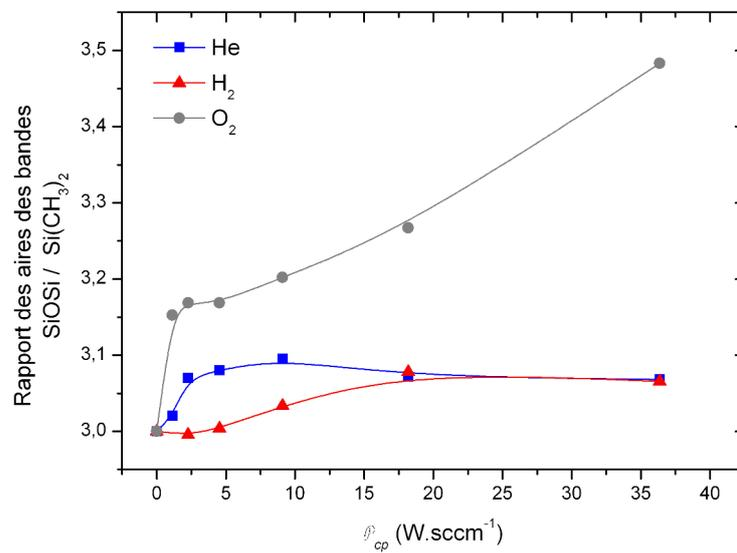
FIGURE 4.17 – Évolution du rapport de la somme des aires des bandes d'absorption des groupements SiOSi sur l'aire de la bande d'absorption des groupements Si(CH<sub>3</sub>)<sub>2</sub> en fonction de  $\mathcal{P}_{cp}$ .
