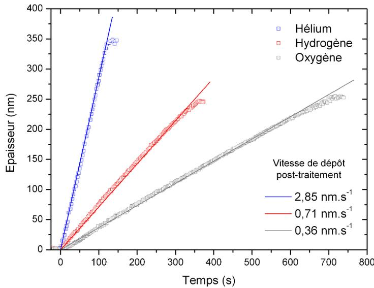
**FIGURE 3.15** – Évolution en temps réel de l'épaisseur des films minces au cours de la croissance pour les trois cas étudiés en fonction du temps de traitement et mesurée à  $\lambda = 750$  nm. Conditions de dépôt au **tableau 3.3**.
