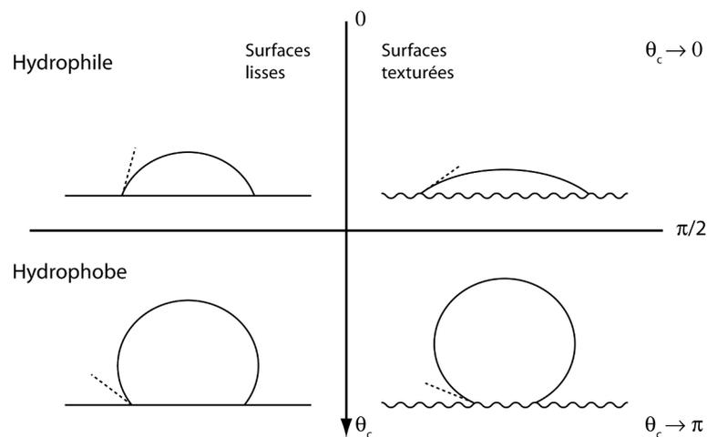
**FIGURE A.7** – Influence de la texturation sur l'équilibre du contact entre une goutte de liquide et une surface solide.
