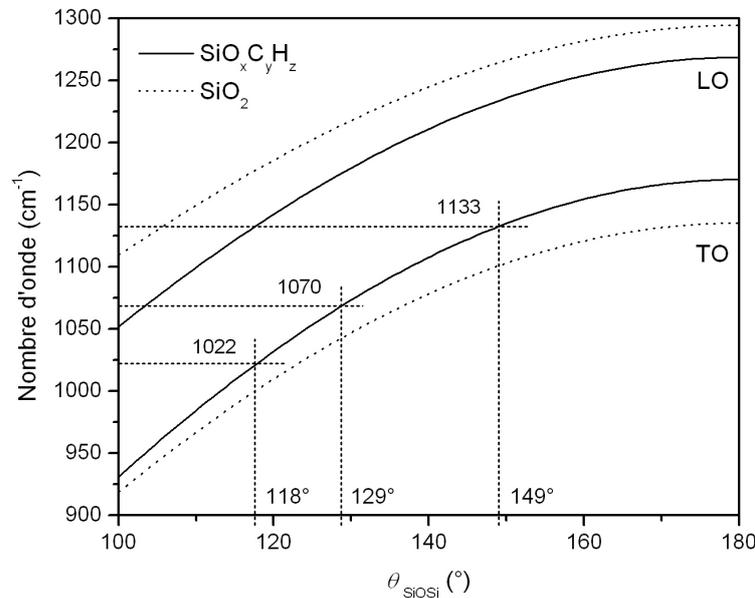
**FIGURE 4.23** – Relation entre l'angle de la liaison SiOSi et la fréquence de vibration calculée des modes TO et LO de l'élongation asymétrique de SiOSi dans le cas d'une silice et d'un polysiloxane plasma.
