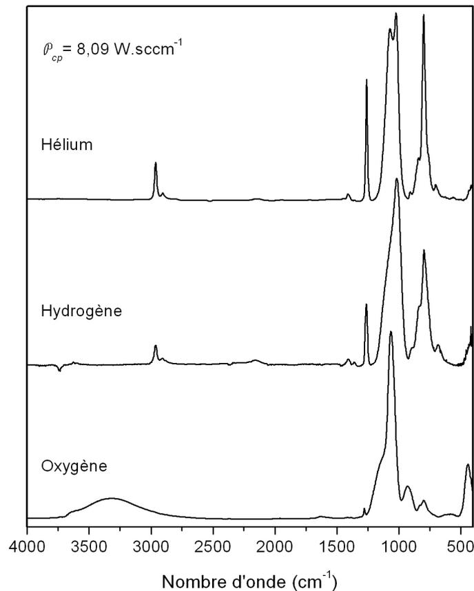
**FIGURE 4.24** – Spectres d'absorption infrarouge de films minces obtenus en mélange OMCTSO et hélium, hydrogène, oxygène.
