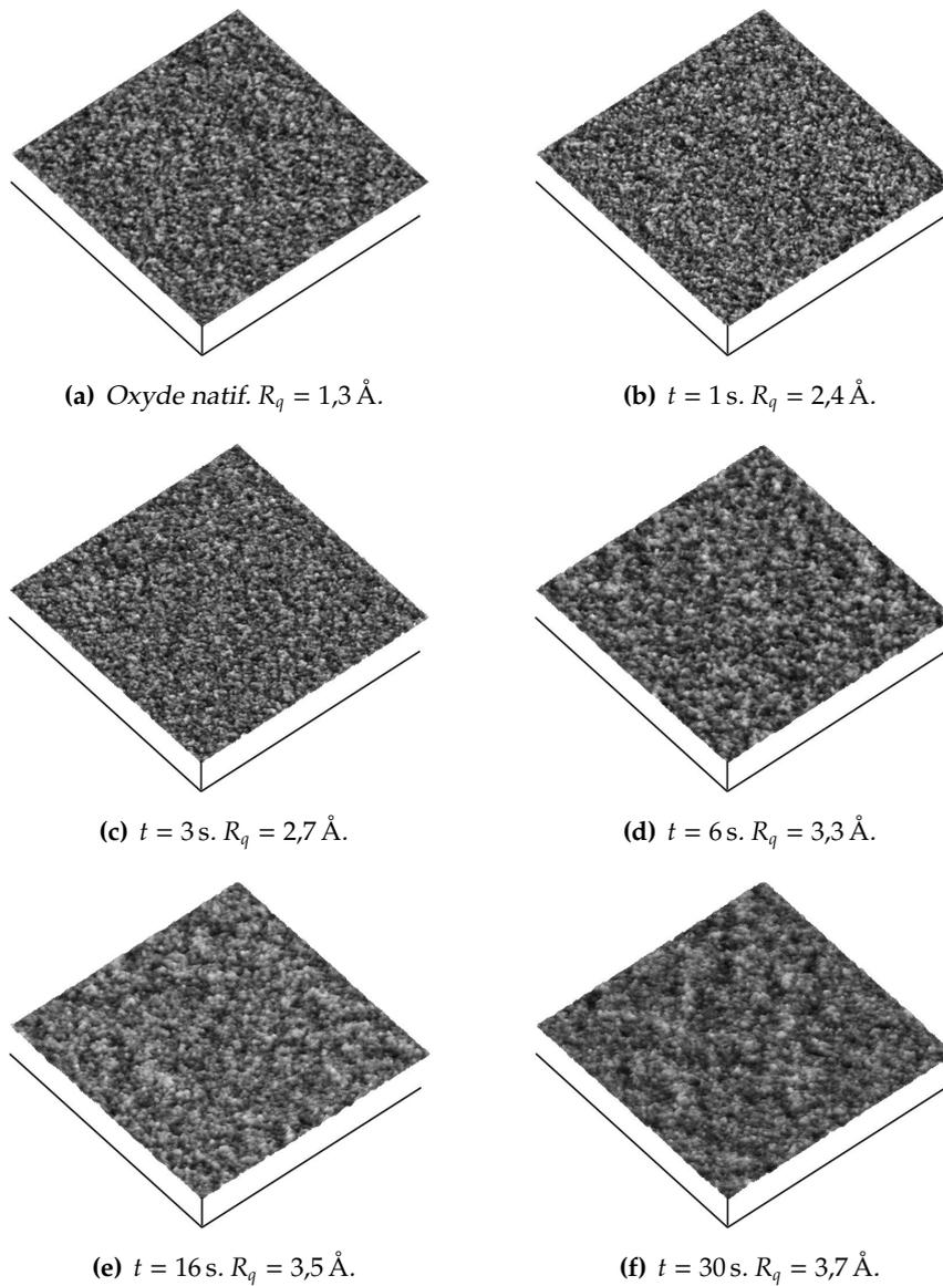
**FIGURE 3.18** – Images AFM de la surface de tranches de silicium monocristallin poli revêtues de PDMS-like obtenu par PECVD à partir d'OMCTSO et d'hélium pour différents temps de traitement. Paramètres de dépôt au **tableau 3.3**. Échelles :  $x, y = 500 \text{ nm}$  ;  $z = 30 \text{ nm}$ .
