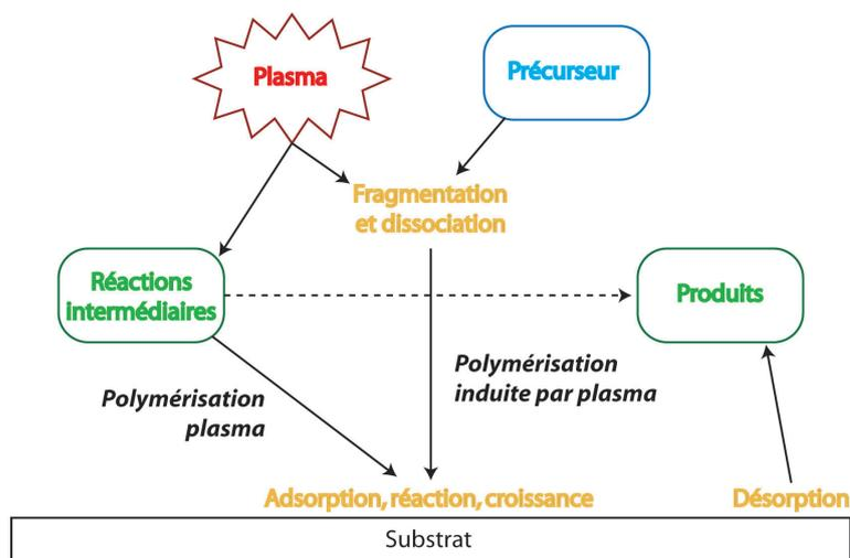
FIGURE 1.1 – Schéma de principe de la polymérisation plasma.
