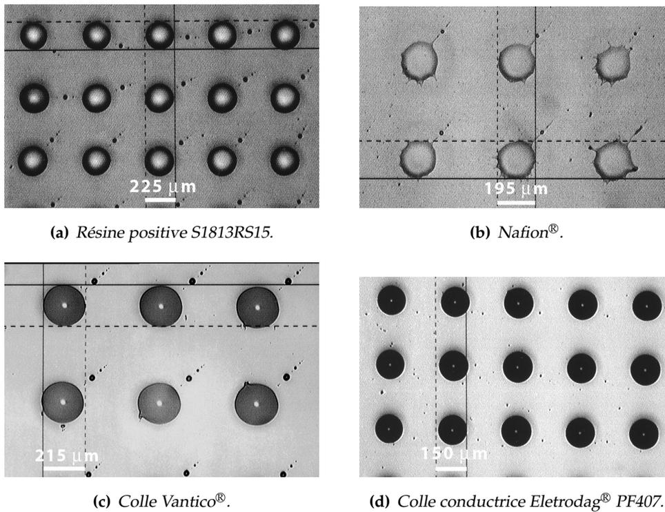
**FIGURE 6.2** – Exemples de localisations microscopiques par *spin-coating* sur lames de verre revêtues de 100 nm polydiméthylcyclosiloxane plasma traité localement par exposition UVO au travers d'un masque mécanique. Crédit photographique : LETI/DOPT.
