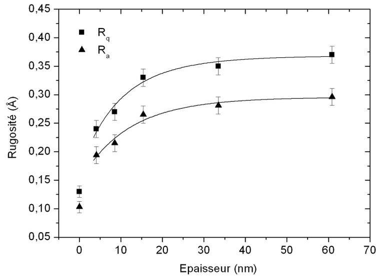
**FIGURE 3.19** – Évolution de la rugosité en fonction de l'épaisseur du dépôt pour des couches minces obtenues à partir d'un mélange OMCTSO et hélium sur des tranches de silicium monocristallin et poli. Conditions de dépôt au **tableau 3.3**.
