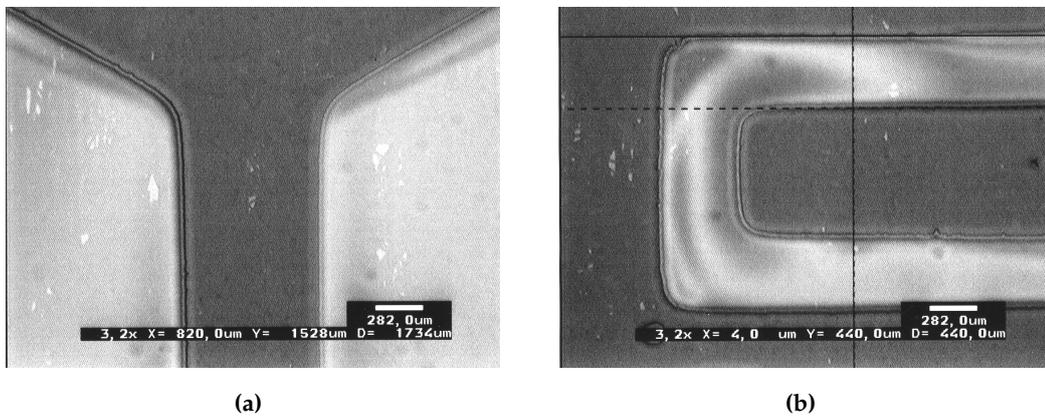
**FIGURE 6.4** – Exemples de motifs obtenus par spin-coating de résine positive S1813RS15 grâce au traitement localisé par UVO du polydiméthylcyclosiloxane plasma au travers d'un masque optique. Crédit photographique : LETI/DOPT.
