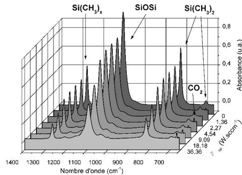
(f) Détail de la bande d'absorption 1400-600  $\text{cm}^{-1}$  dans le cas de l'oxygène.
