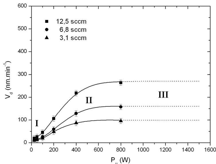
**FIGURE 3.3** – Évolution de la vitesse de dépôt dans le cas d'un gaz de dilution oxydant (oxygène) en fonction de la puissance délivrée par le générateur pour différents débits de gaz de précurseur.
