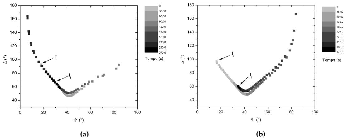
**FIGURE 3.12** – Suivi des paramètres ellipsométriques  $\Psi$  et  $\Delta$  à  $\lambda = 350$  nm pendant la croissance du dépôt en conditions réductrices (a) et oxydantes (b). Paramètres de dépôt au **tableau 3.3**.
