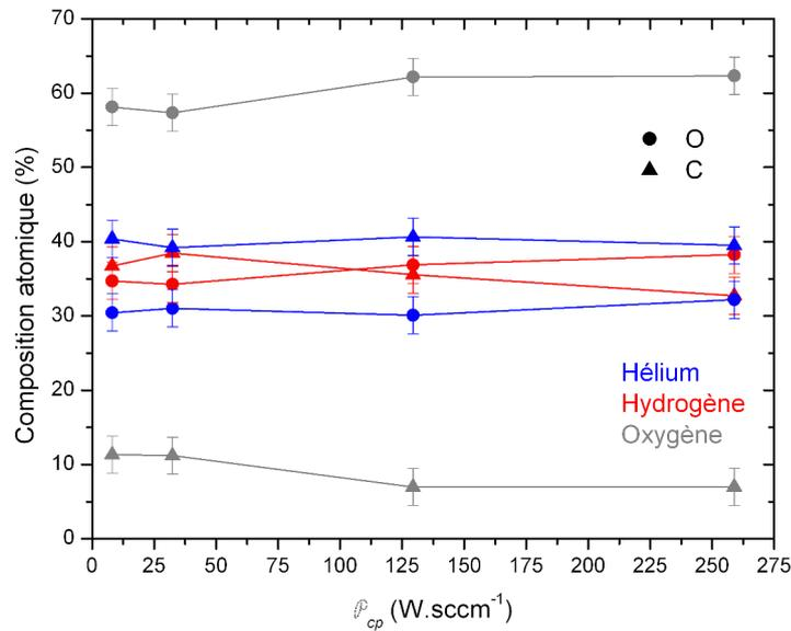
FIGURE 4.2 – Évolution de la composition atomique des matériaux en fonction de  $P_{cp}$ .
