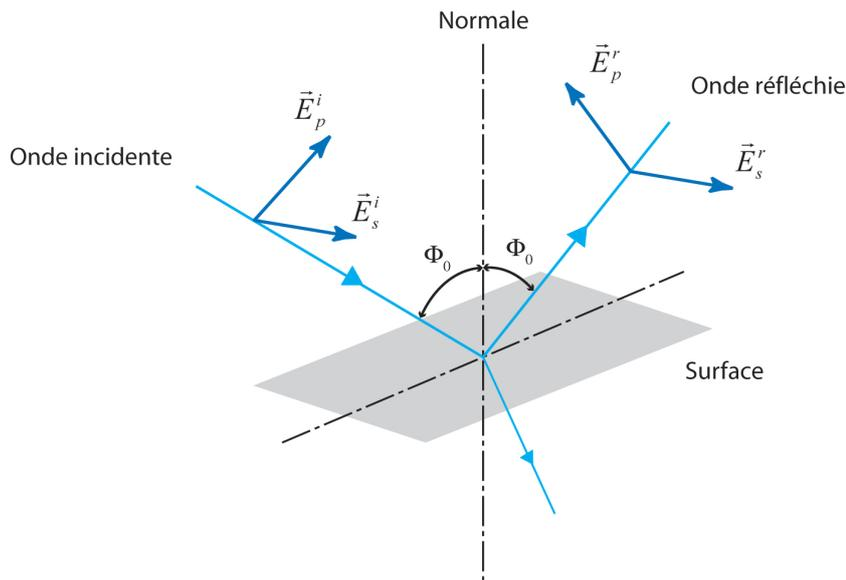
FIGURE 2.3 – Réflexion des axes de polarisation à la surface.
