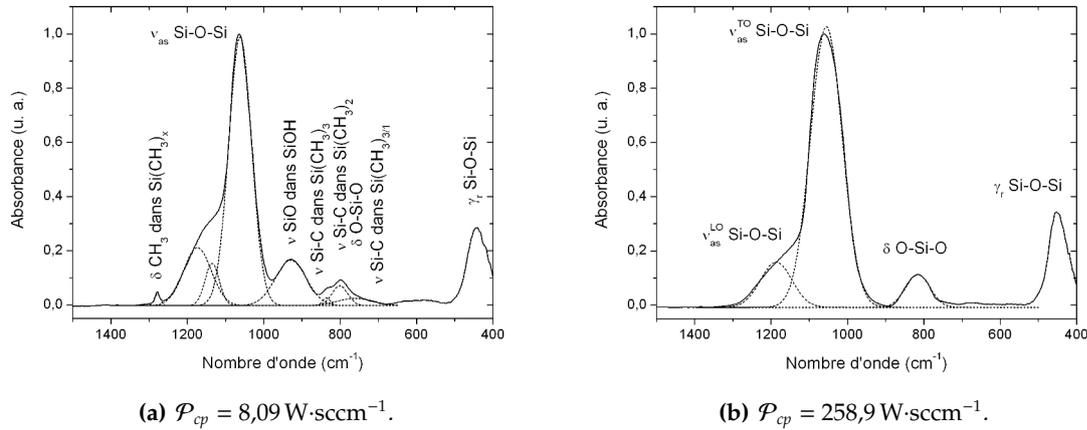
**FIGURE 4.30** – Spectres d'absorption infrarouge entre  $1500 \text{ cm}^{-1}$  et  $400 \text{ cm}^{-1}$  pour deux valeurs de  $\mathcal{P}_{cp}$  pour le cas de l'oxygène.
