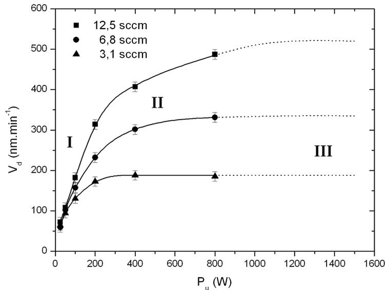
**FIGURE 3.1** – Évolution de la vitesse de dépôt dans le cas d'un gaz de dilution neutre (hélium) en fonction de la puissance délivrée par le générateur pour différents débits de gaz de précurseur.
