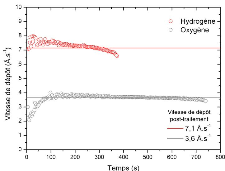
**FIGURE 3.16** – Évolution de la vitesse de dépôt en fonction du temps de traitement en conditions réductrices et oxydantes. Conditions de dépôt au **tableau 3.3**.
