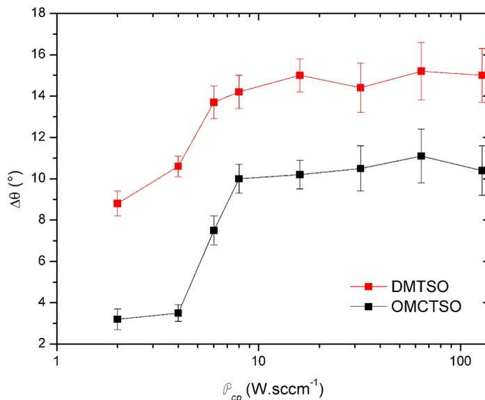
**FIGURE 5.10** – Évolution de l’hystérésis de l’angle de contact en fonction de  $\mathcal{P}_{cp}$  pour des polysiloxanes plasma élaborés à partir de décaméthyltétrasiloxane (DMTSO, conformation linéaire) et d’octaméthylcyclotétrasiloxane (OMCTSO, conformation cyclique).
