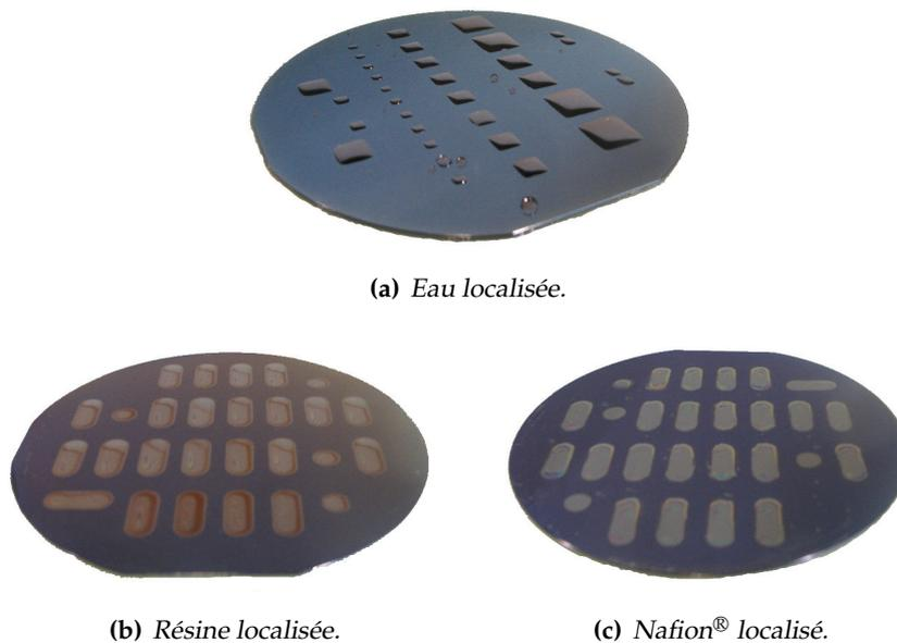
**FIGURE 6.1** – Exemples de localisations macroscopiques par simple trempage sur tranches de silicium de 100 mm revêtues de 100 nm polydiméthylcyclo-siloxane plasma traité localement par exposition à un plasma d'hélium.
