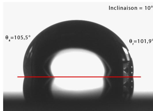
**FIGURE 5.6** – Mise en évidence du phénomène d’ancrage de la ligne triple par la photographie d’une goutte d’eau de 10  $\mu\text{L}$  sur une surface de polydiméthylcyclosiloxane plasma inclinée de 10°.
