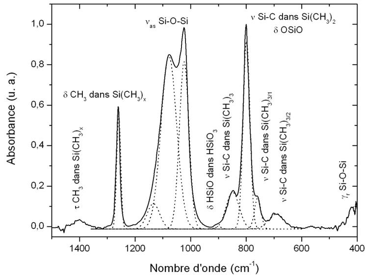
**FIGURE 4.21** – Indexation et déconvolution de la zone d'absorption infrarouge entre 1500 et 400  $\text{cm}^{-1}$  pour un film mince réalisé à partir d'une décharge de précurseur pur. Conditions de dépôt au **tableau 4.8**.
