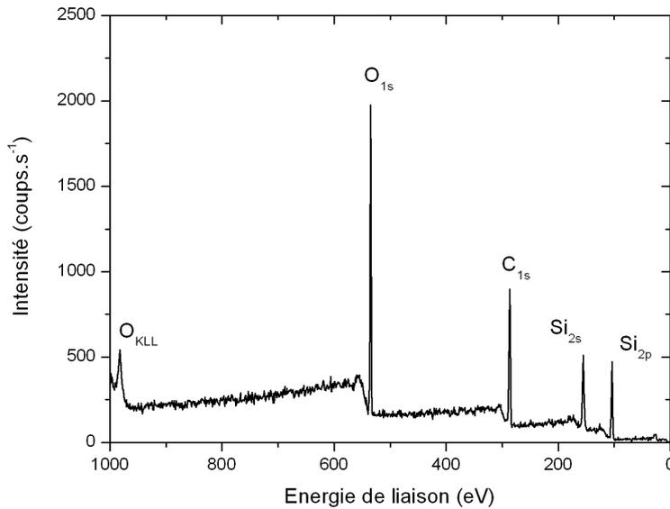
**FIGURE 4.1** – Spectre XPS typique d'un film mince de polysiloxane plasma obtenu à partir d'un mélange OMCTSO/He.
