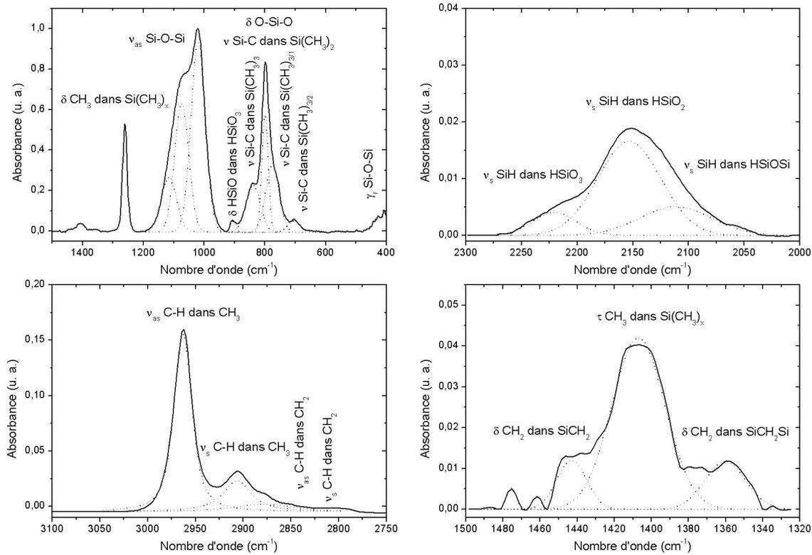
**FIGURE 4.26** – Détails de bandes d'absorption infrarouge d'un spectre de la figure 4.25 pour le cas de l'hélium à  $\mathcal{P}_{cp} = 32,36 \text{ W} \cdot \text{sccm}^{-1}$ .
