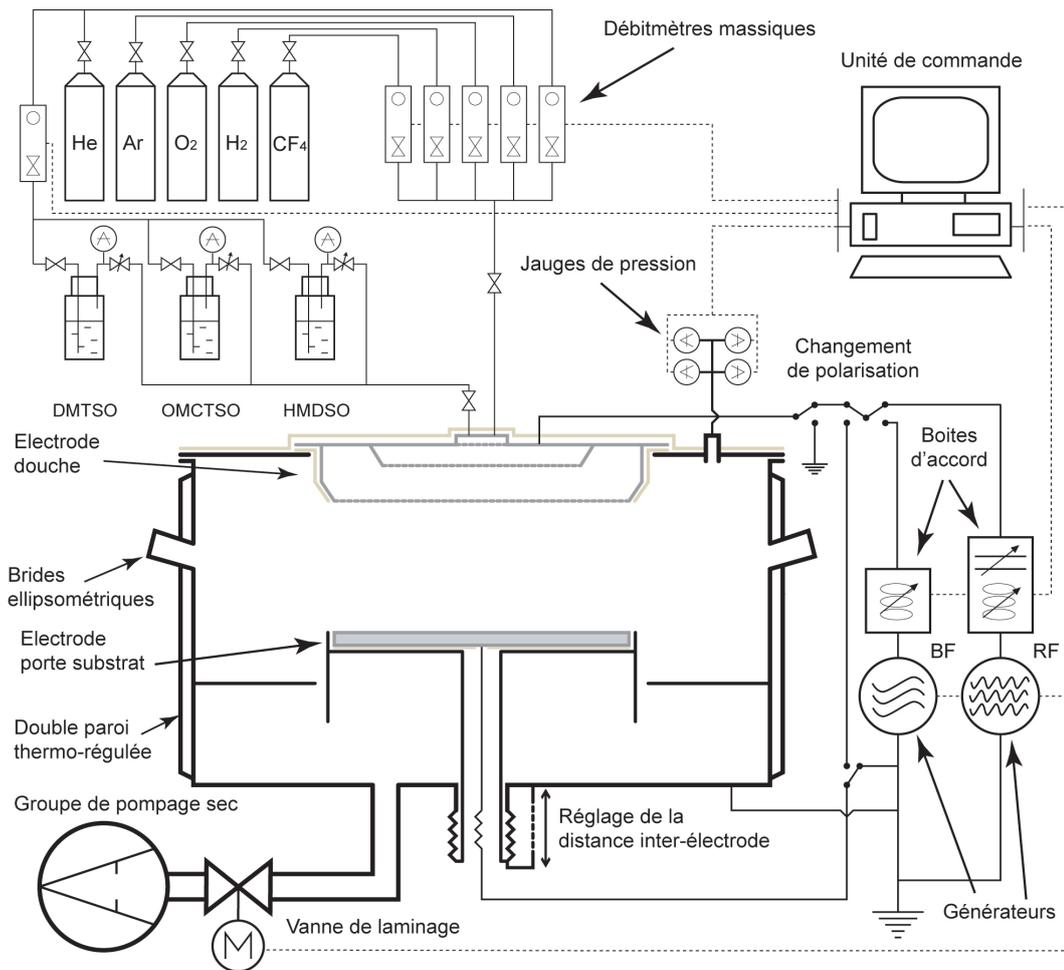
FIGURE 1.2 – Représentation schématique du réacteur de dépôt PECVD.
