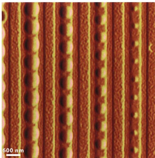
**FIGURE B.2** – Exemples de lignes post-traitées par exposition laser (image AFM).
