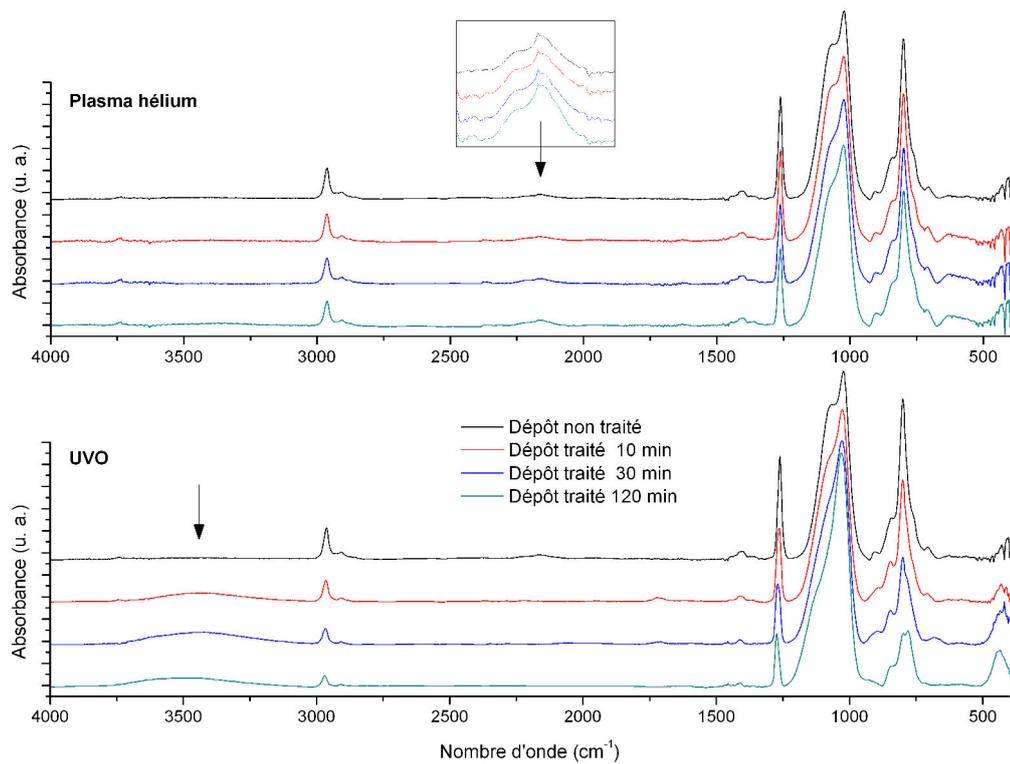
**FIGURE 5.13** – Spectres d'absorption infrarouge de dépôts traités par plasma hélium et UVO pour différents temps de traitement.
