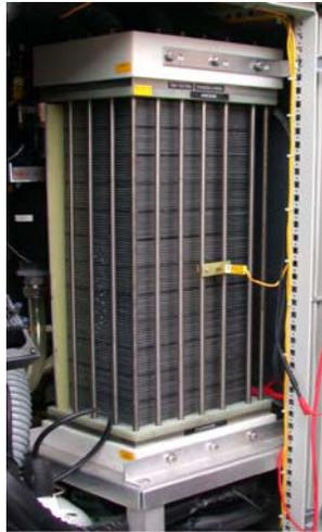
**Figure 1.9 :** Emplacement vertical du stack (pile HPOWER, Gaz de France).
