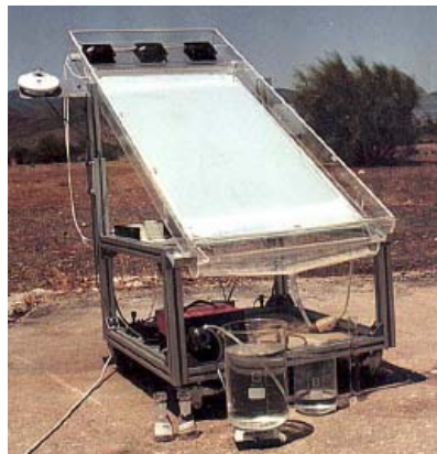
Figure 1-17. Réacteur solaire plan installé sur la plate-forme solaire d'Almeria en Espagne [Bahnmann et al., 2004].
