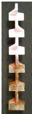
Figure 2-21. Photographie du lit photocatalytique nommé « mélangeur statique » fabriqué par la méthode d'imprégnation (hauteur imprégnée : 6,7 cm; \sigma = 0,97 \text{ mg/cm}^2 ).
