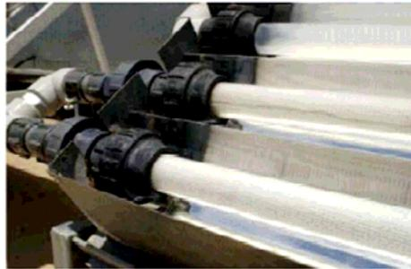
**Figure 1-19.** Réacteur solaire muni de collecteurs CPC concentrant l'énergie solaire au niveau des parois de tubes recouverts de dioxyde de titane [Fernández et al., 2005].
