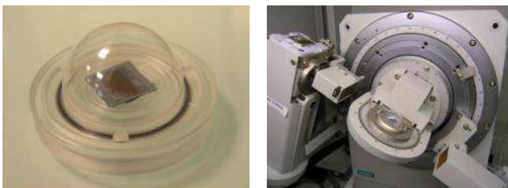
Figure III-13 : Photographies du porte-échantillon sous argon et du dispositif de diffraction RX en incidence rasante Siemens D5000 associé
