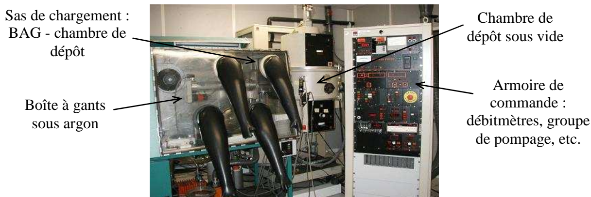
Figure VI-1 : Bâti PVD Alcatel SCM 600 équipé d'une boîte à gants
