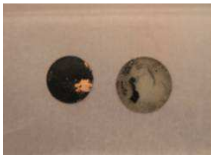
Figure III-30 : Electrode de germanium dense de 200 nm d'épaisseur déposée sur cuivre et démontée en BAG après 300 cycles
