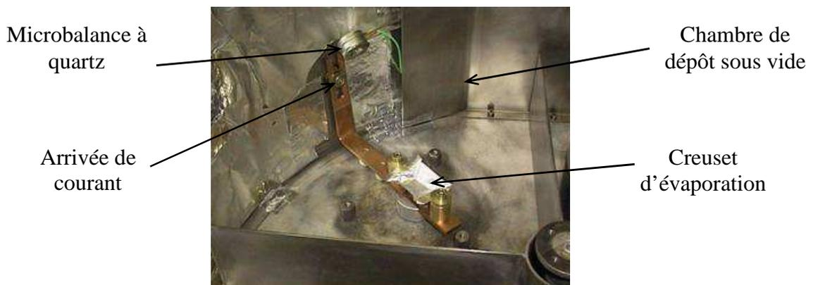
Figure IV-4 : Creuset pour l'évaporation du lithium
