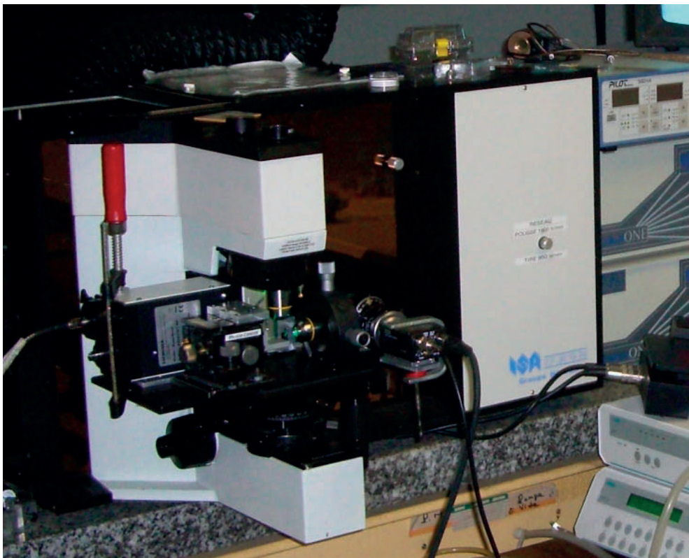
FIG. 2.11 – Montage micro-Raman à 90^\circ adapté sur le spectromètre Raman LabRam Horiba Jobin Yvon, vue large.
