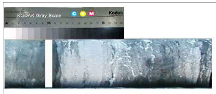
Figure 84: argilite anhydritique prélevée pour l'expérimentation batch. Des sulfates superficiels masquent localement l'aspect argileux de la matrice (cotes 165,20-166m, sondage C 3129).
