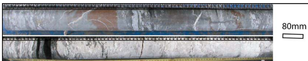
Figure 9: exemple de la variabilité d'organisation des sulfates (en blanc) dans les Marnes à anhydrite (sondage CB3129).
