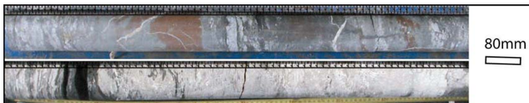
Figure 9: exemple de la variabilité d'organisation des sulfates (en blanc) dans les Marnes à anhydrite (sondage CB3129).
