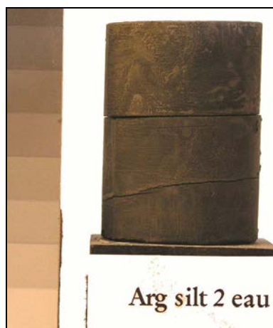
Figure 87: fractures substratiformes dans une éprouvette cylindrique d'argilite silteuse. Ces fractures font suite à une immersion d'au moins quelques heures dans une saumure saturée ou dans de l'eau déminéralisée.
