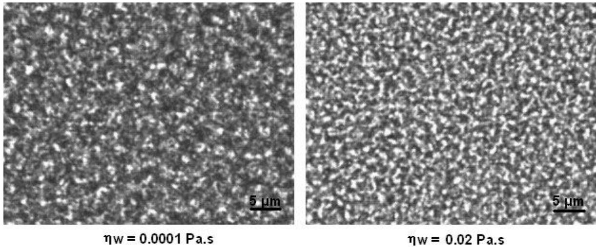
*Figure D-1. Clichés microscopiques des émulsions finales E/H préparées à fw 0,7, avec des phases aqueuses de viscosités différentes ( $\eta_w = 0,0001$  et  $0,01 \text{ Pa.s}$ ) mais une même viscosité pour la phase huileuse ( $\eta_o = 0,0001 \text{ Pa.s}$ )*
