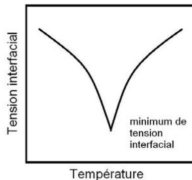
**Figure IV-15 : Variation typique de la tension interfaciale de systèmes eau-huile-surfactif avec le changement de la formulation. (d'après Salager, 2000<sup>b</sup>)**
