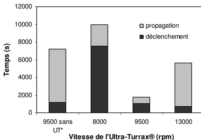
**Figure VI-17 : Temps de déclenchement et de propagation de l'inversion pour des systèmes à  $fw = 0,9$ , en changeant la vitesse de rotation de l'Ultra-Turrax®. UT\* : Ultra-Turrax® arrêté après le déclenchement de l'inversion**
