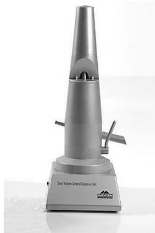
**Figure II-11 : Préparateur liquide utilisé avec le Malvern**
