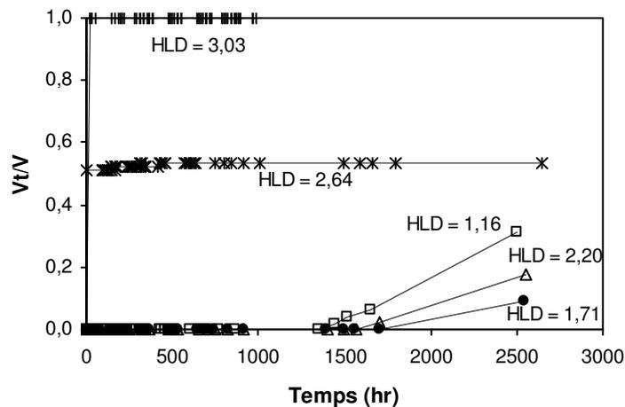
**Figure IV-26 : Fraction volumique de phase aqueuse séparée au cours du temps pour des émulsions E/H préparées à  $fw = 0,8$  et à différentes formulations globales**
