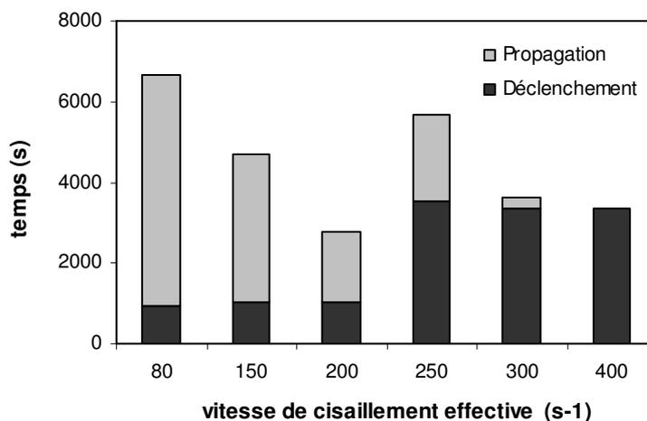
**Figure VI-13 : Temps du déclenchement et d'inversion pour des systèmes avec  $f_w = 0,9$  en fonction de la vitesse de cisaillement effective de l'outil de macromélange (ancree)**
