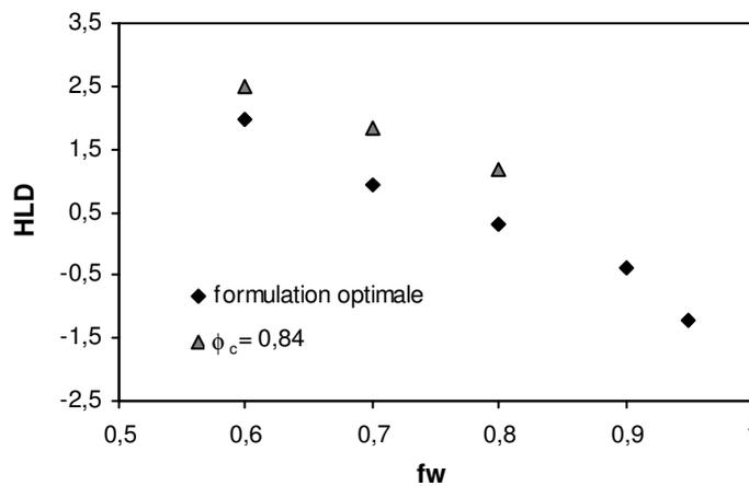
**Figure IV-9 :** HLD des systèmes présentant la même valeur  $\phi_c$  expérimentale (0,84), en fonction de  $f_w$
