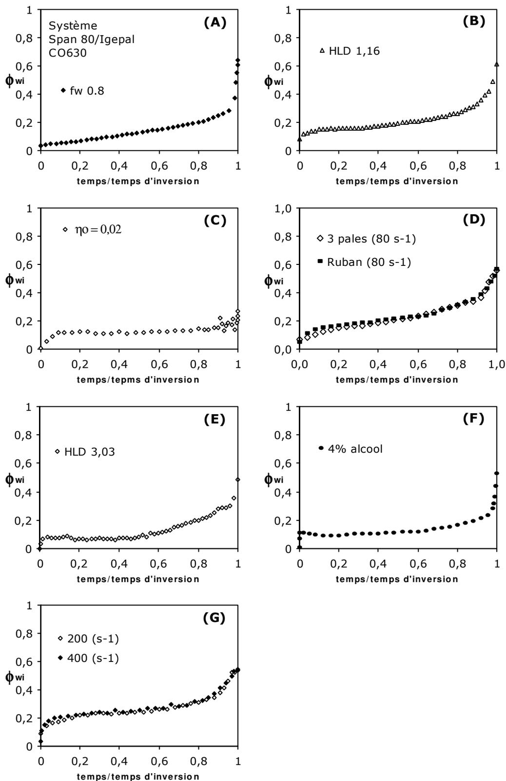
Figure VII-2 : Cinétiques d'inclusion accélérées avant l'inversion
