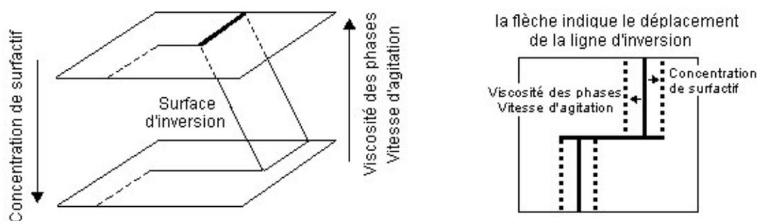
**Figure I-12 : Représentations en trois et deux dimensions de l'effet des variables de composition et d'agitation sur la ligne et la surface d'inversion**
