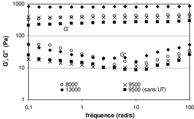
**Figure VI-19 :** Spectres mécaniques des systèmes préparés à la même formulation, mais agités en utilisant de vitesses du rotor-stator (Ultra-Turrax®) différents. Le système appelé « sans UT » correspond au système où l'outil disperseur a été éteint une fois l'inversion déclenchée
