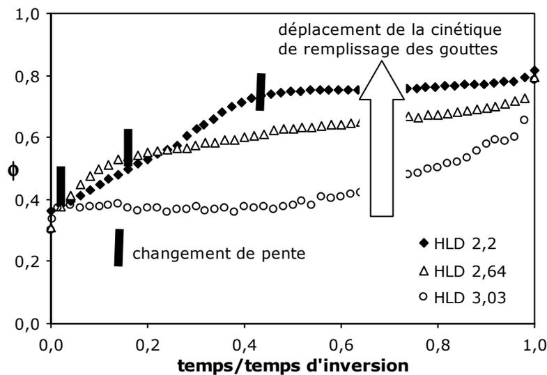
**Figure IV-4 : Changements de la cinétique d'inclusion de gouttes avec la formulation globale du système. HLD compris entre 3,03 et 2,2 ;  $f_w = 0,7$**
