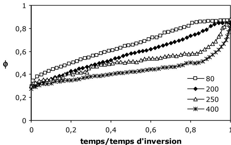
Figure VI-12 : Changement de la cinétique d'inclusion des gouttelettes de phase externe avec l'augmentation de la vitesse de cisaillement effective de l'outil de macromélange (ici l'ancre) pour  $fw = 0,9$
