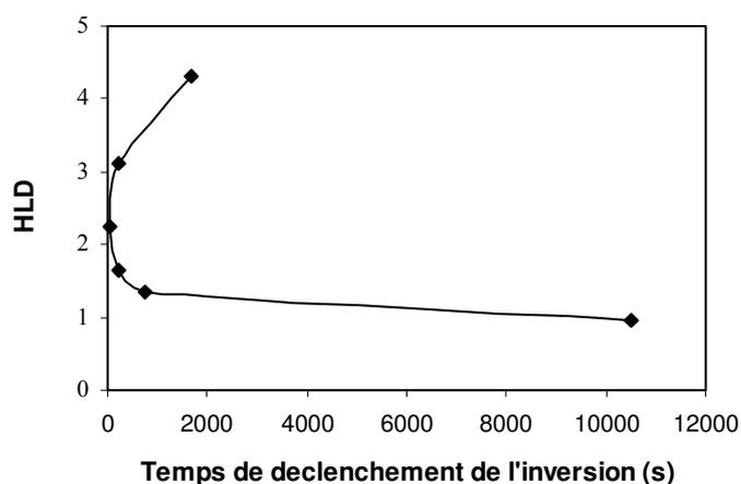
**Figure IV-19 : Influence de la formulation du système sur le temps d'agitation et de mélange nécessaire pour déclencher l'inversion de phase**
