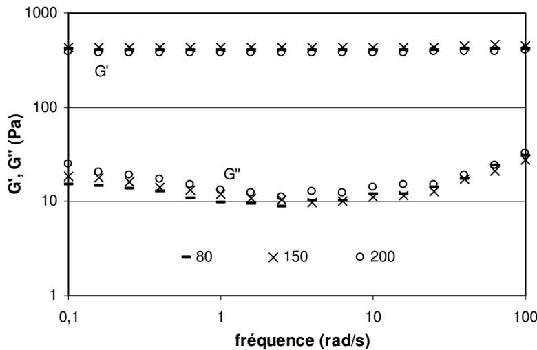
**Figure VI-16 :** Spectres mécaniques des émulsions préparées avec des vitesses d'agitation de l'ancre différent. Groupe des émulsions où le déclenchement a lieu rapidement (Figure VI-13).  $fw = 0,9$
