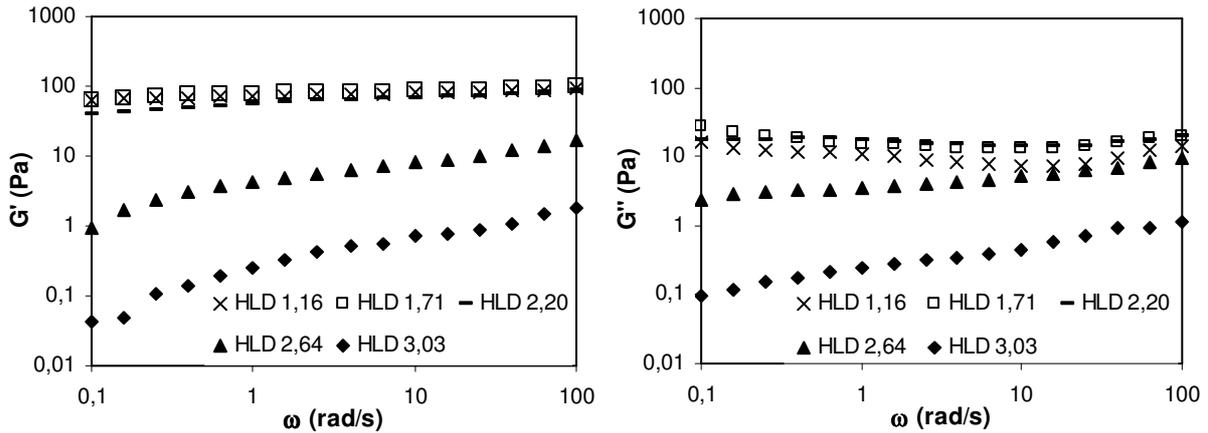
**Figure IV-25 : Balayage en déformation des émulsions contenant 80% de phase interne en fonction de la formulation du système**
