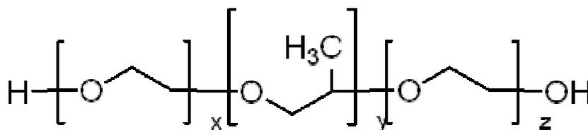
**Figure II-3 : Structure moléculaire du Synperonic PE/F68 (d'après Sigma-Aldrich)**
