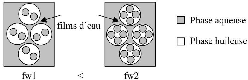
**Figure IV-17 :** Représentation simplifiée des émulsions multiples à la même fraction de phase dispersée mais avec des valeurs totales différentes de  $fw$
