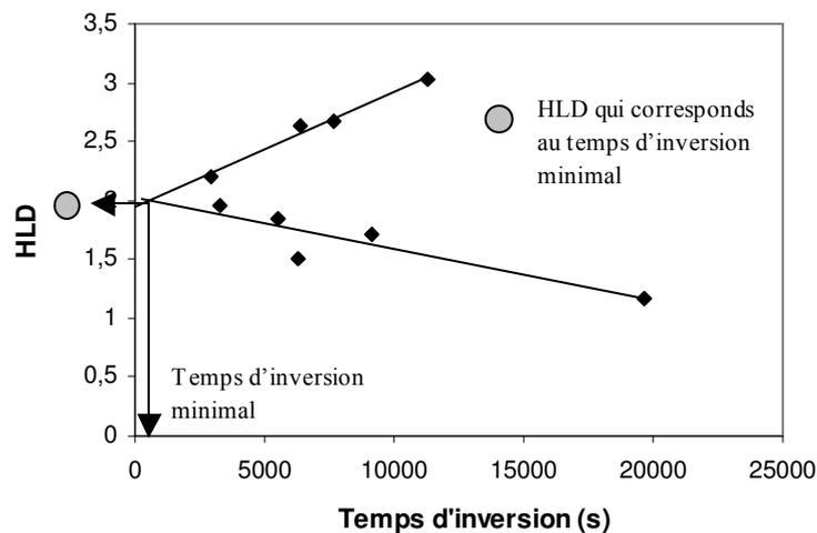
**Figure IV-3 : Temps d'agitation et de mélange nécessaire pour déclencher l'inversion des systèmes à des formulations globales (HLD) différentes pour  $f_w = 0,7$ .**
