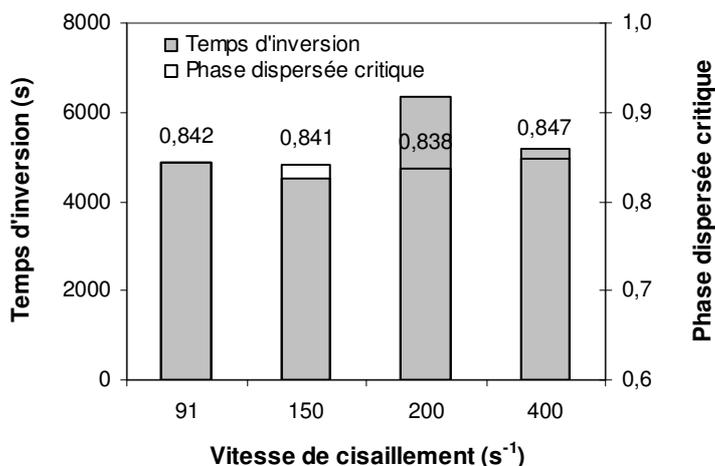
**Figure VI-10 :** Temps d'inversion et fraction de phase dispersée critique obtenus avec l'ancre comme outil de macromélange pour différentes vitesses de cisaillement effectives et pour  $fw = 0,7$
