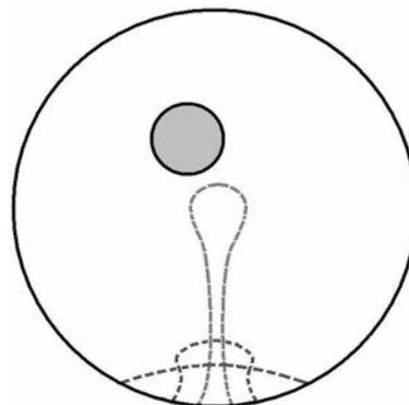
**Figure I-14 : Schématisation du mécanisme d'inclusion par déformation à la surface des gouttes (d'après Sajjadi, 2002<sup>b</sup>)**
