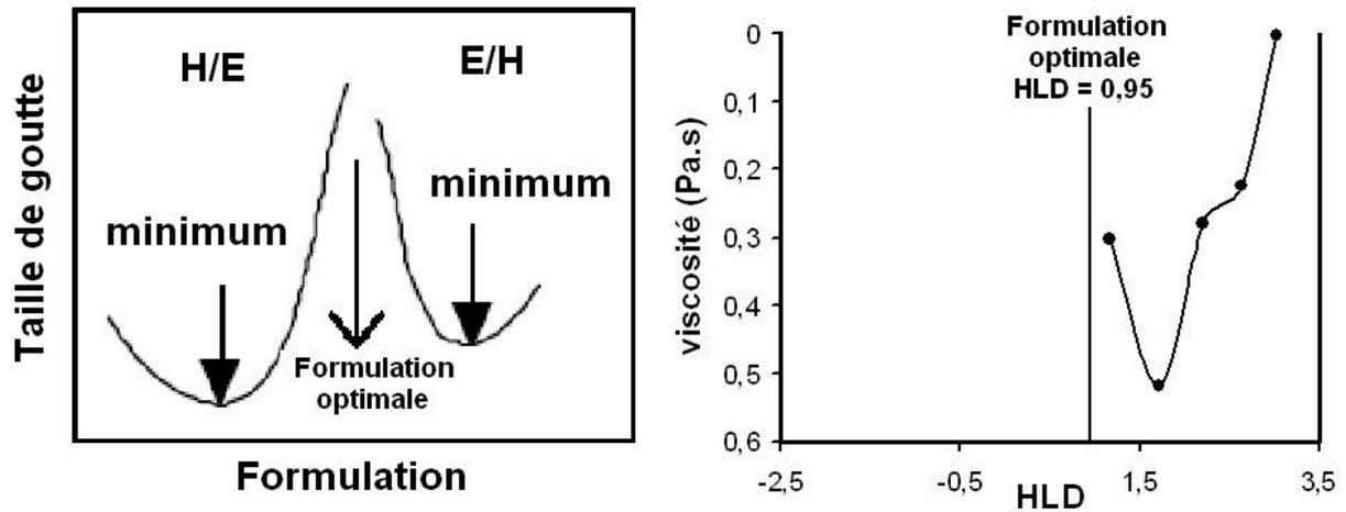
Figure IV-22 : Comparaison du schéma de la taille de gouttes en fonction de la formulation, proposé par Salager (2000<sup>b</sup>) avec les valeurs expérimentales de viscosité en fonction du HLD
