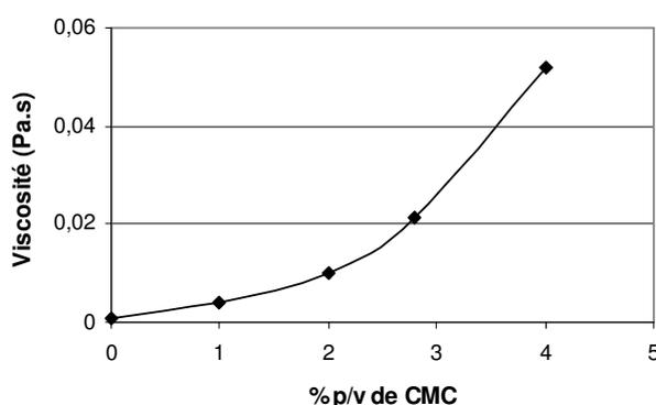
**Figure II-4 : Évolution de la viscosité de la phase aqueuse en fonction de la concentration en CMC**
