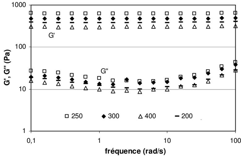
**Figure VI-15 :** Spectres mécaniques des émulsions préparées avec des vitesses d'agitation de l'ancre plus fortes. Groupe des émulsions où le déclenchement a lieu tardivement (Figure VI-13).  $fw = 0,9$
