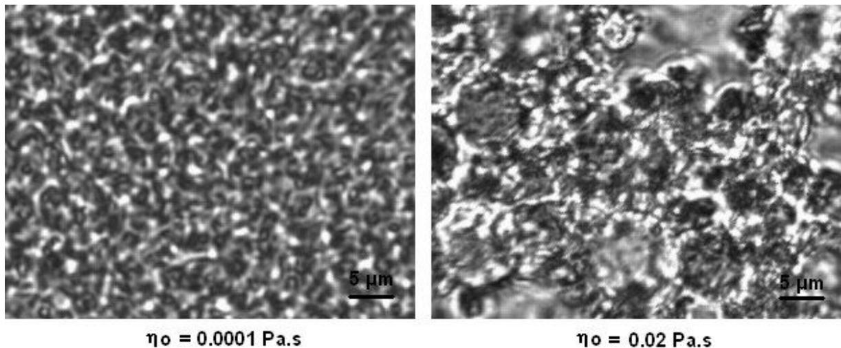
*Figure D-2 : Clichés microscopiques des émulsions finales E/H préparées à fw 0,6, avec des phases huileuses de viscosités différentes ( $\eta_o = 0,0001$  et  $0,02 \text{ Pa.s}$ ) mais une même viscosité pour la phase aqueuse ( $\eta_w = 0,0001 \text{ Pa.s}$ )*
