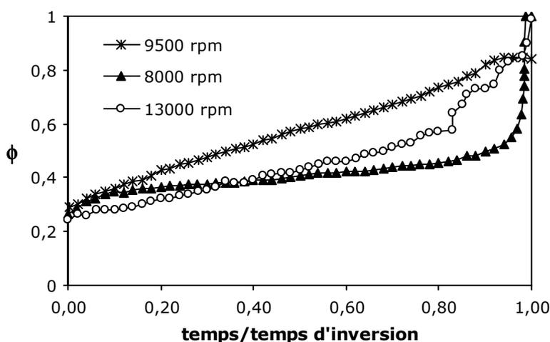
**Figure VI-18 : Évolution de la phase dispersée en fonction du temps normalisé (1 représentant le temps du déclenchement de l'inversion), pour des émulsions fabriquées à  $f_w = 0,9$  et différentes vitesses d'agitation de l'Ultra-Turrax®**
