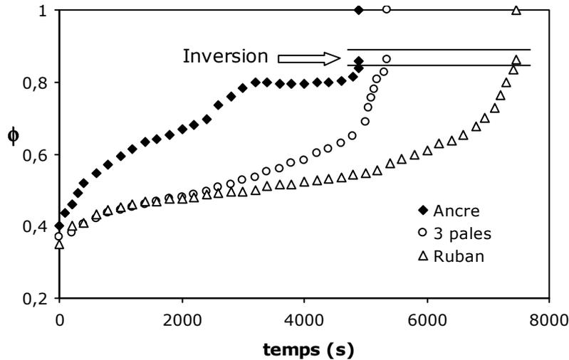
**Figure VI-1 : Évolution de la fraction de phase dispersée sous agitation d'un système à  $HLD = 1,84$  et  $fw = 0,7$  avec trois outils de macromélange différents ( $\dot{\gamma}_{eff} = 80 \text{ s}^{-1}$ )**
