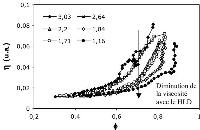
*Figure IV-6 : Viscosité des systèmes e/H/E en cours d'agitation en fonction de la fraction de phase dispersée*
