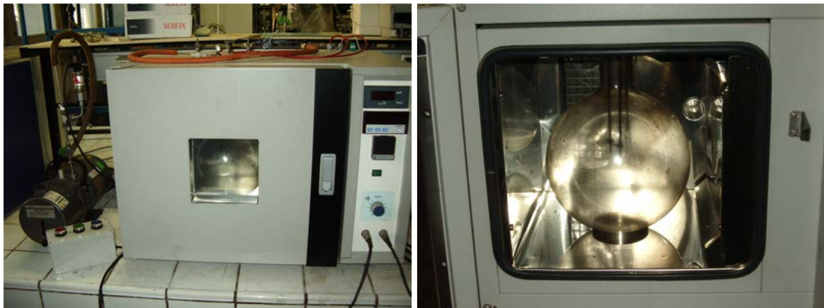
Figure A6-1 : Photographie de l'appareillage de détermination de l'inflammabilité des gaz et vapeurs-Chilworth Technology Ltd.
