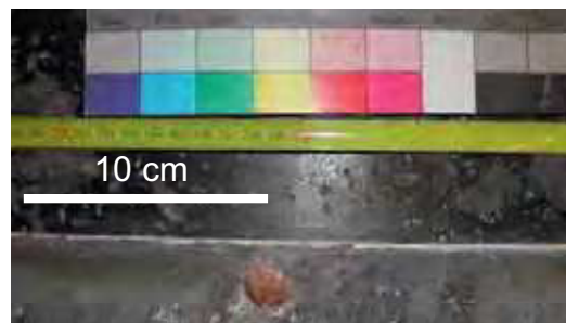
Figure 17 - Détail d'un élément de gypse saccharoïde rose à 8,5 m
