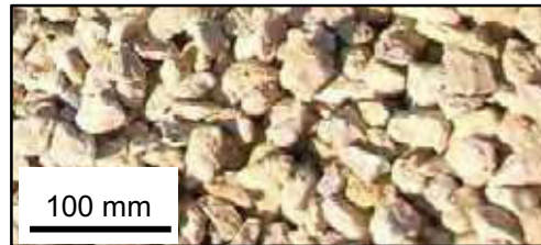
Figure II 14 - Calcaire à polypiers concassé.
