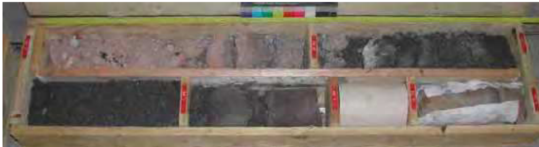
Figure 2 - Carotte de 0 à 3 m
