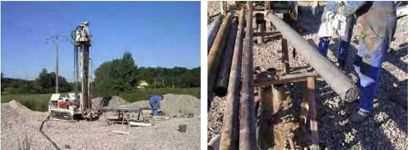
Figure 1 - Sondeuse lors de la réalisation du sondage carotté SC1 (gauche) et opération de prélèvement d'un échantillon intact (droite).
