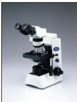
**Figure II.6. Photographie du microscope optique BX51.**
