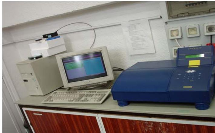
Figure 2.5 : UV-Visible spectrophotomètre SECOMAN Anthélie Light<sup>®</sup> relié à un PC
