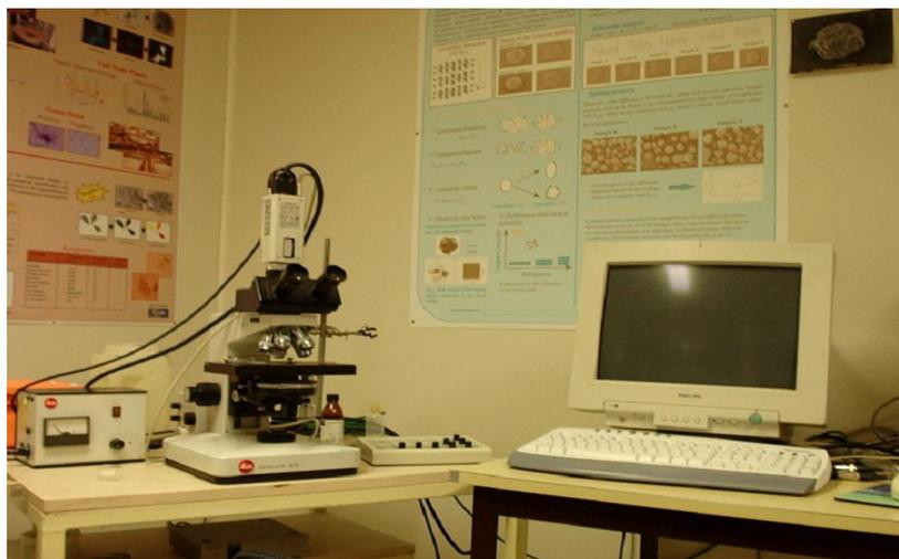
Figure 2.25 : Systèmes d'acquisition des images
