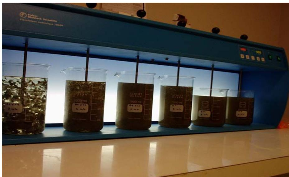
Figure 2.4 : Installation de l'analyse Jar Test
