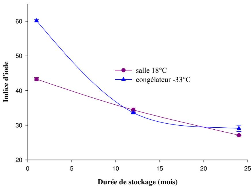
**Figure 57 :** Les indices d'iode des huiles extraites au CO<sub>2</sub> supercritique des fruits de l'aiélé stockés à 18°C et à -33°C
