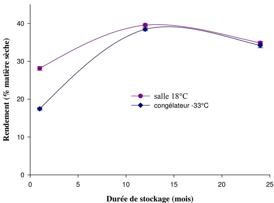
**Figure 48:** Le rendement d'extraction au CO<sub>2</sub> supercritique du beurre des graines de karité stockées à 18°C et à -33°C
