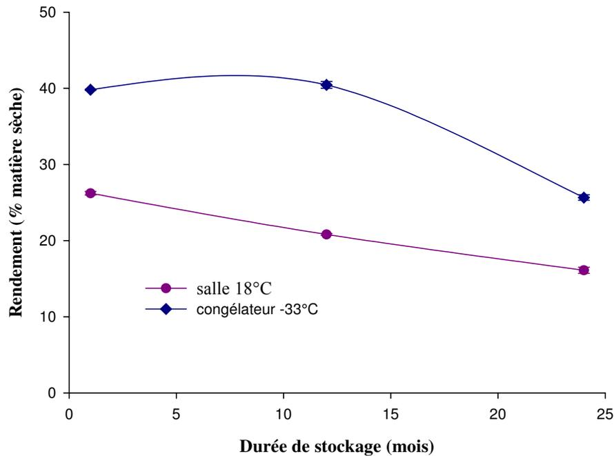
**Figure 49 :** Le rendement d'extraction au CO<sub>2</sub> supercritique de l'huile des fruits de l'aiélé stockés à 18°C et à -33°C
