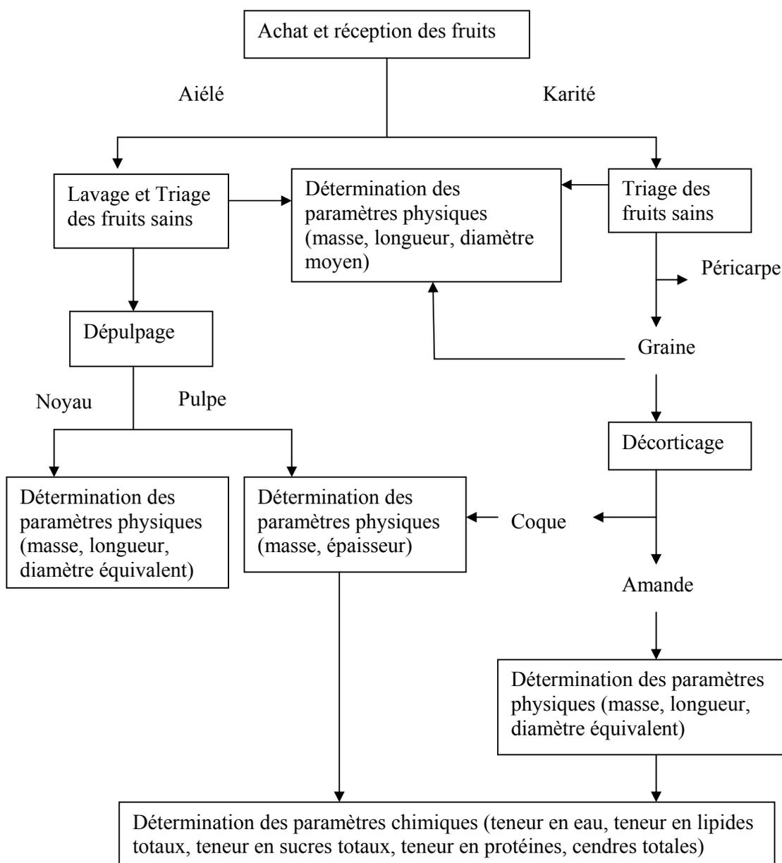
**Figure 18** : Le schéma général de caractérisation des fruits
