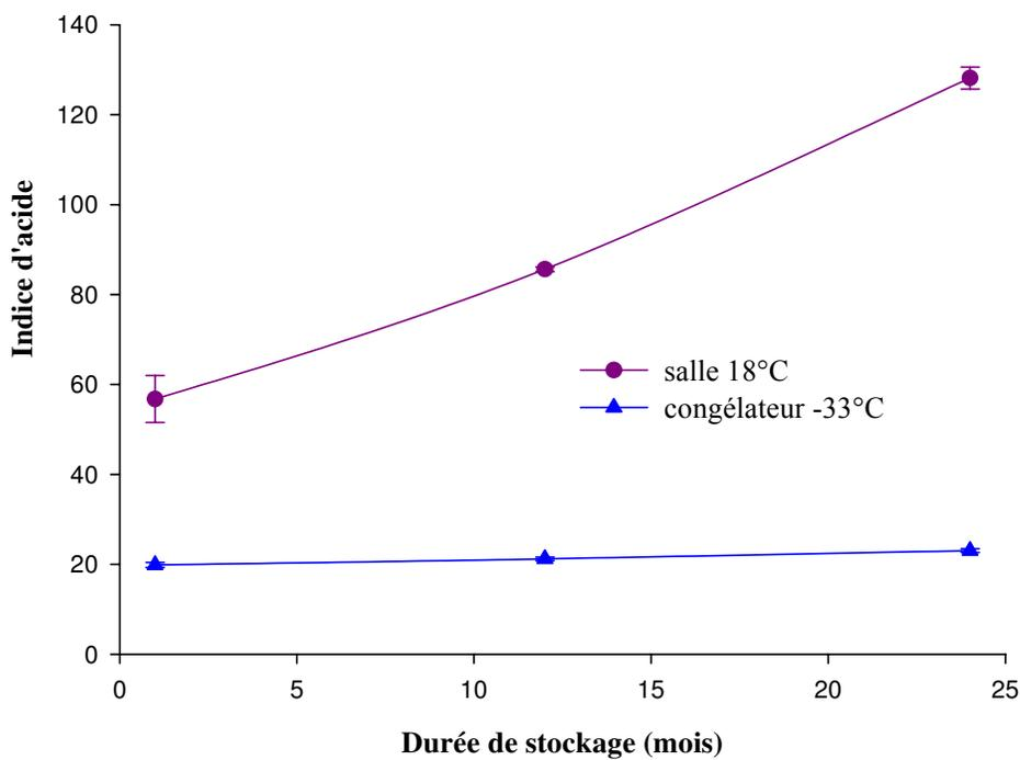
**Figure 51 :** Les indices d'acide des beurres extraits au CO<sub>2</sub> supercritique des graines de karité stockées à 18°C et à -33°C
