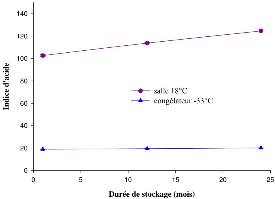
**Figure 53 :** Les indices d'acide des huiles extraites au CO<sub>2</sub> supercritique des fruits de l'aiélé stockés à 18°C et à -33°C
