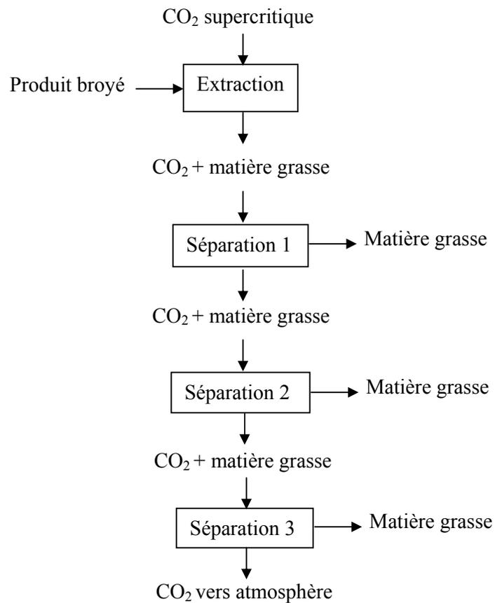
**Figure 40 :** Le schéma de procédé d'extraction dynamique supercritique
