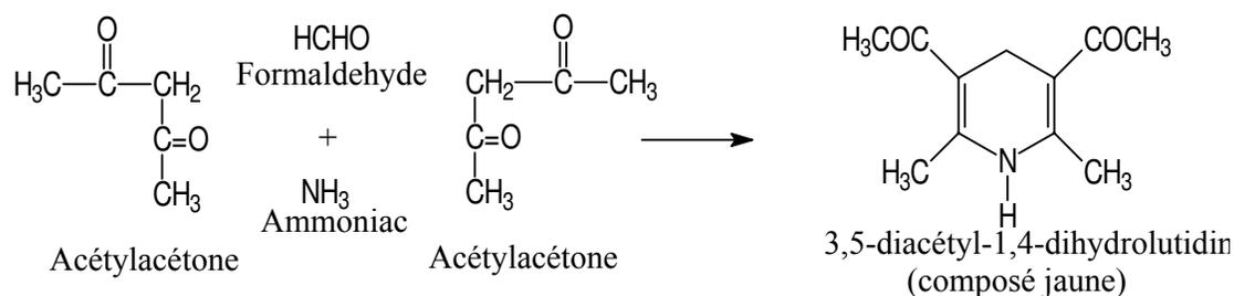
**Figure 19** : L'équation de la réaction de Hantzsch (Devani *et al.*, 1989)
