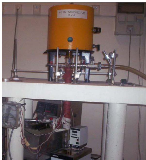
Planche 11 : La photographie de la microbalance
