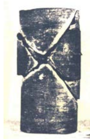
(b) Rupture par bifurcation localisée – par cisaillement
