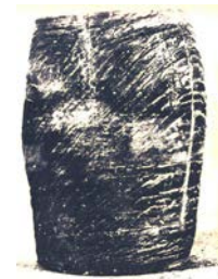
(c) Déformation plastique ductile – mise en tonneau
