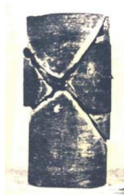
(b) Rupture par bifurcation localisée – par cisaillement
