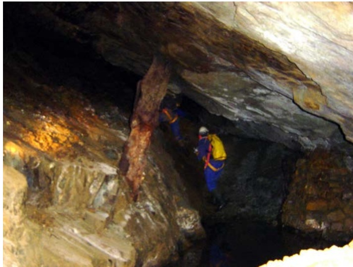
Figure 1.14. Méthode d'exploitation par gradins renversés et reste de boisage
