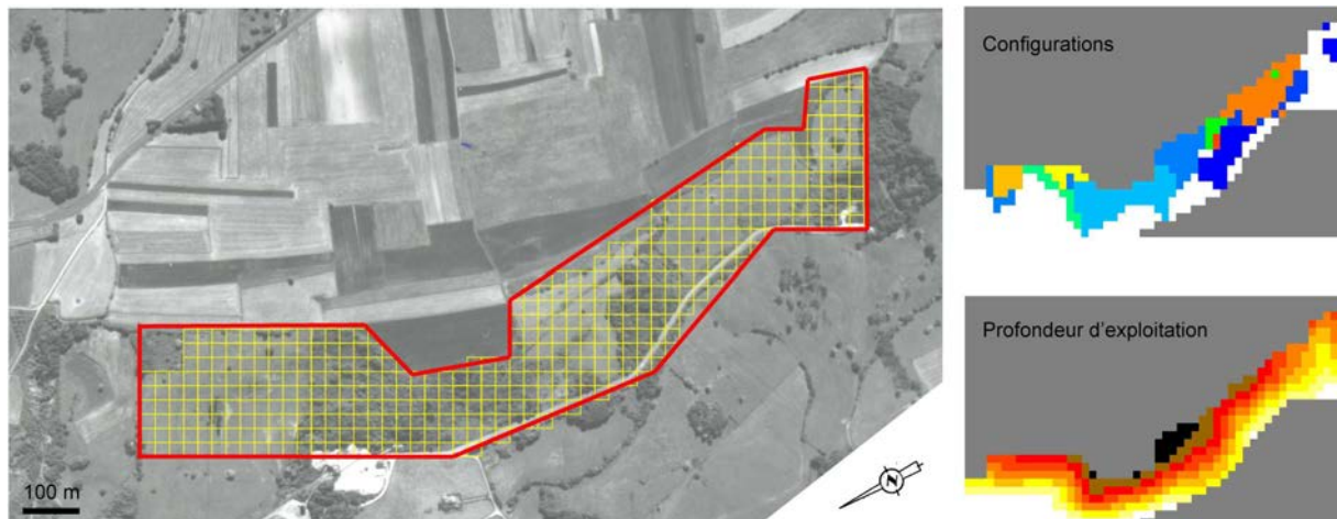
Figure 3.19. Maillage de la zone d'étude et caractérisation de chaque maille par des informations relatives au dimensionnement des travaux (géométrie et date d'exploitation) ou au recouvrement (profondeur des travaux)
