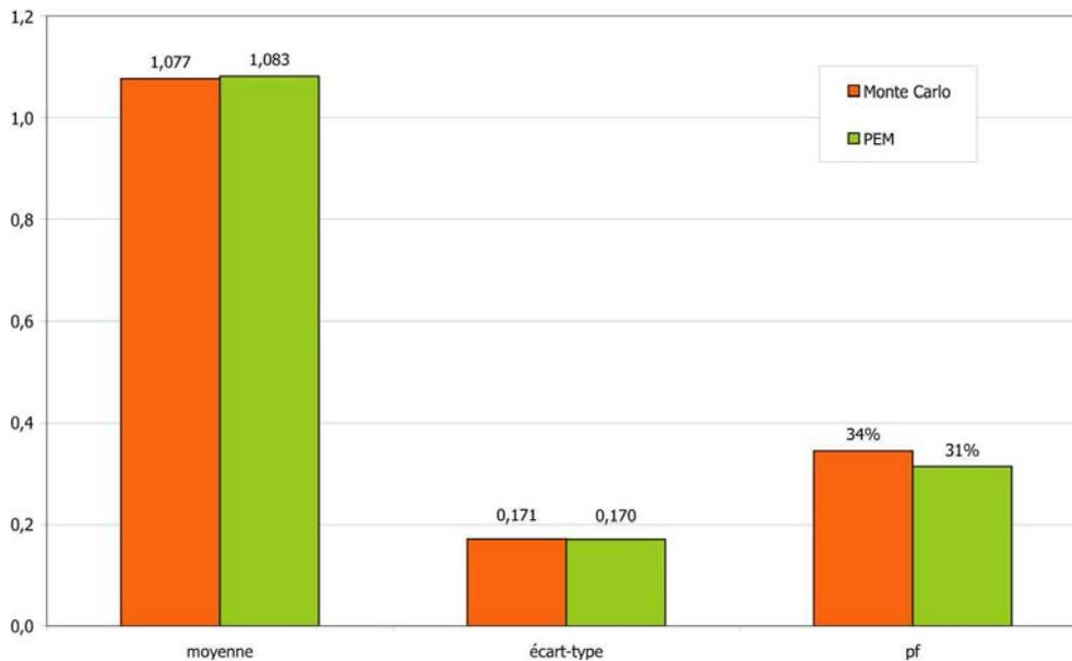
Figure 2.9. Influence des méthodes utilisées pour propager l'incertitude (simulations de Monte Carlo VS Point Estimate Method) sur la caractérisation du facteur de sécurité du pilier de mine
