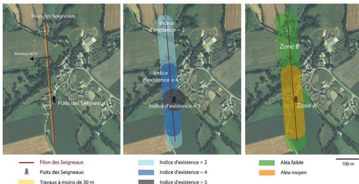
Figure 1.18. Zoom sur le secteur de Plouvara où co-existent deux zones d'aléa faible : le niveau de l'un s'explique par son intensité, celui de l'autre par le doute sur l'existence de l'ouvrage
