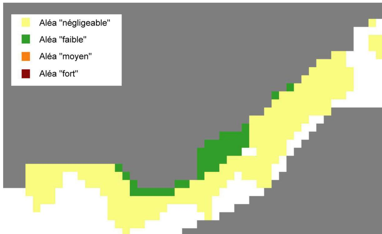
Figure 3.31. Carte probabiliste pour l'aléa « effondrement dû une rupture de pilier »
