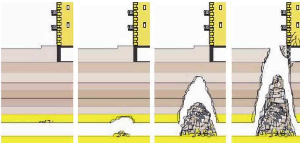
Figure 2.18. Mécanisme de développement d'un fontis
