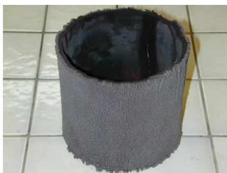
FIG. 3.69: Dépôt de fer obtenu sur cylindre tournant après 5 jours de manipulations. m = 1,560\text{kg} . ( j = 0,1\text{A} \cdot \text{cm}^{-2} , \omega = 80\text{tr}/\text{min} , rendement faradique \simeq 0,8 ).
