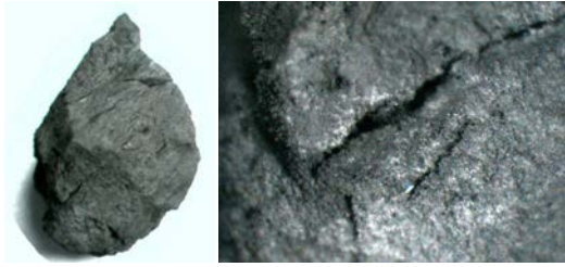
FIG. 3.9: Vue coté électrolyte d'une particule de 5mm de diamètre.
