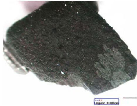
FIG. 3.10: Aspect d'une particule partiellement réduite après manipulation.
