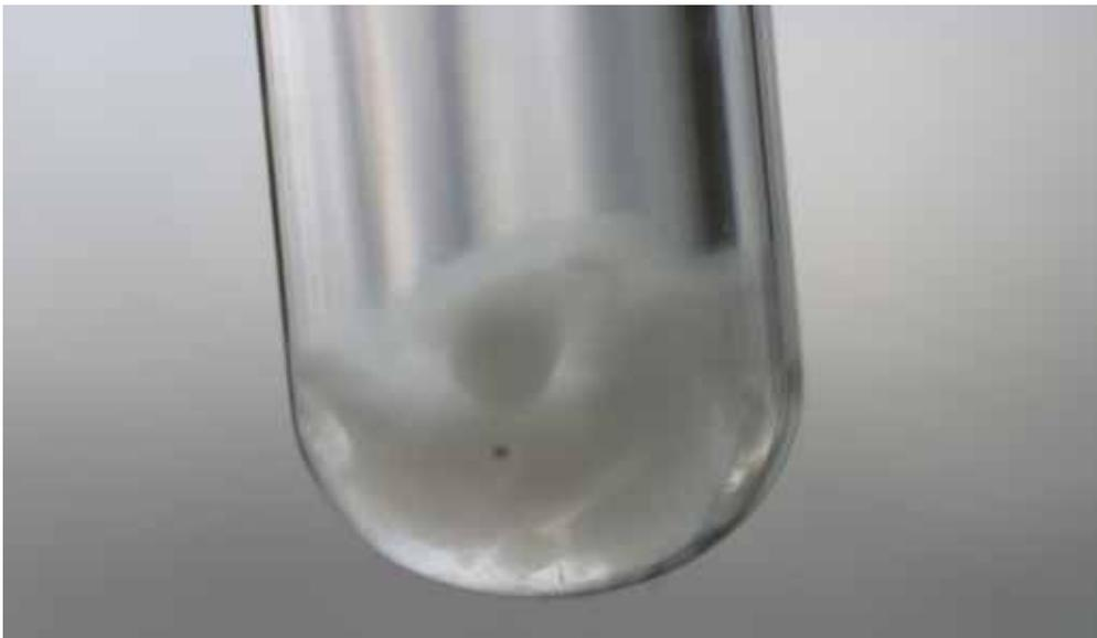
**Figure IV-21 : Aspect des hydrogels dans une solution de NaCl 0,15 M, CaCl<sub>2</sub> 1,4 mM, et putrescine 0,14 mg/ml**
