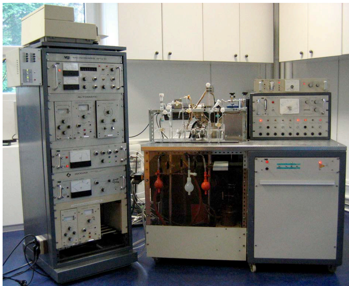
Le spectromètre de masse VG 602d modifié du laboratoire des Isotopes Stables du CRPG
