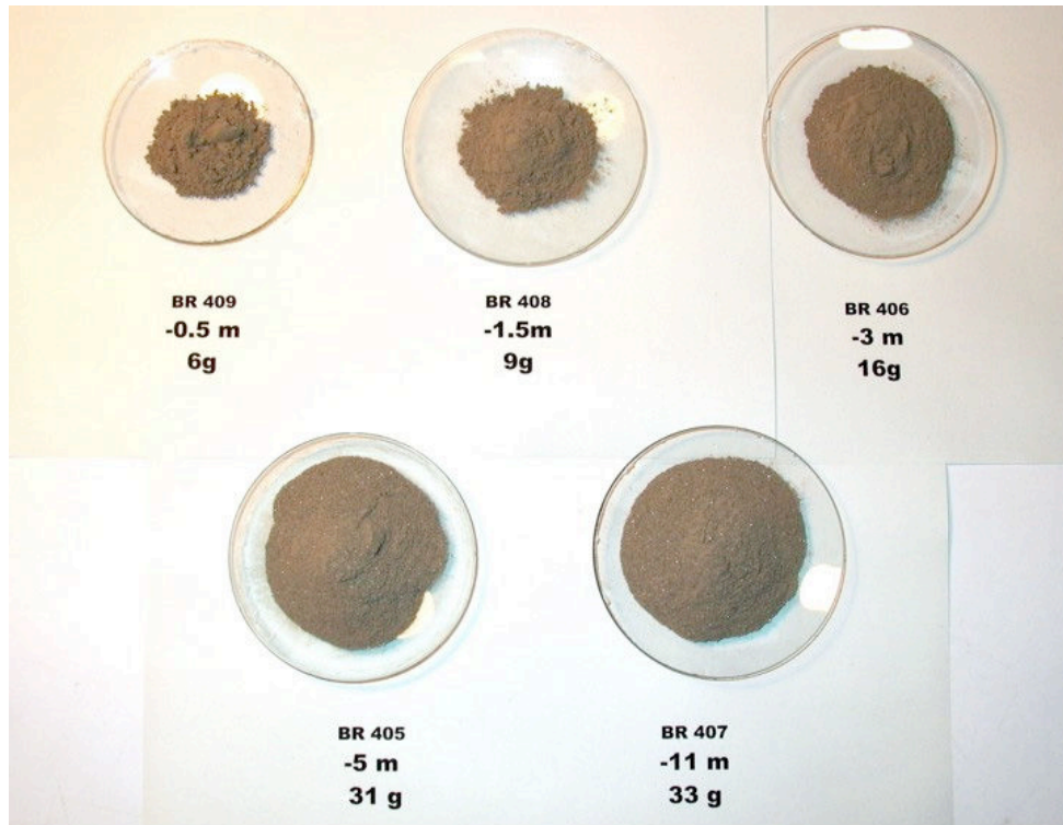
Figure 3.6 : Photographies des matières en suspension du Brahmapoutre collectées à Sirajganj en 2004. La profondeur d'échantillonnage et la masse sont indiquées en dessous de chaque échantillon qui correspond à la totalité des particules extraites après filtration de 5 l d'eau de rivière. L'augmentation de la charge sédimentaire et de la granulométrie avec la profondeur est très nette.
